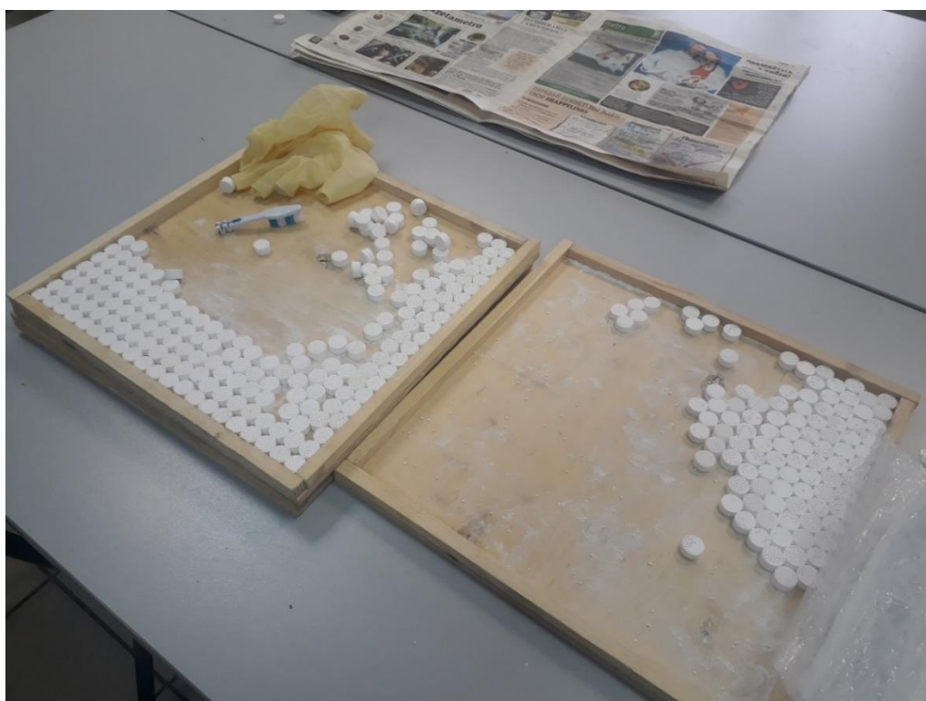
Рисунок 5.40 – керамические изоляторы изготовленные ГШЛ из синтезированного порошка АК12
