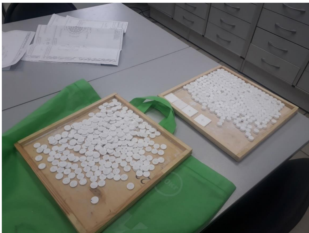
Рисунок 5.39 – керамические изоляторы изготовленные ГШЛ из синтезированного порошка АК12
