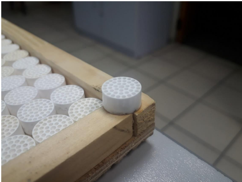
Рисунок 5.37 – керамический изолятор изготовленный ГШЛ из синтезированного порошка АК12
