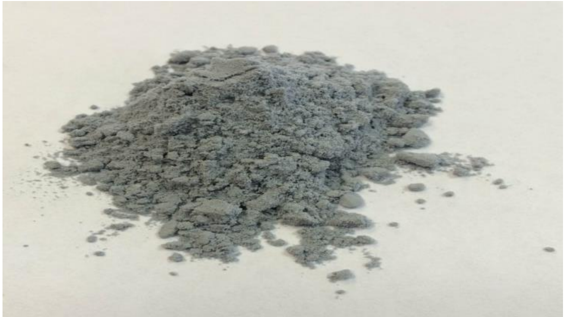
Рисунок 3.13 – Вид порошка после химического диспергирования Al-Mo и термообработки при 1350°C с выдержкой 1 час.
