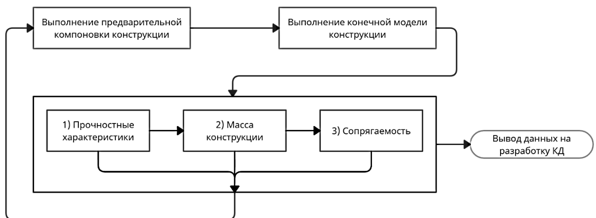
Рисунок 3 – Блок-схема проверки условия соответствия конструкции техническому заданию
