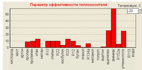
Рис. 7. Параметр Дунбара для некоторых теплоносителей при минус 20 °С
