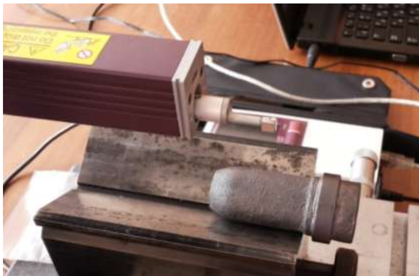
Рис.9.31. Установка композитной камеры сгорания в клиновом держателе.
