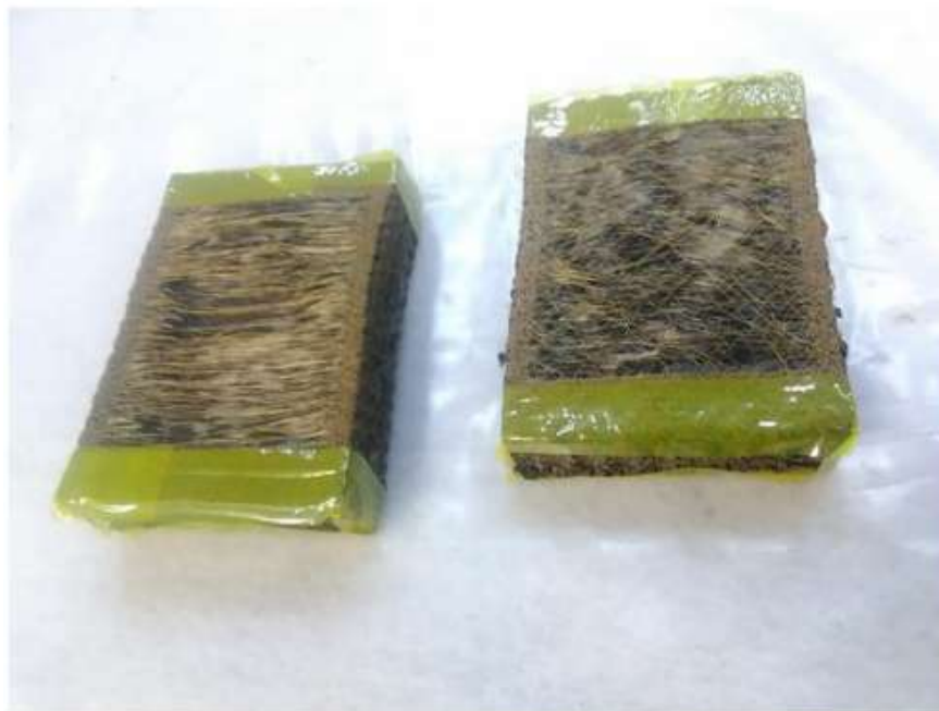
Рисунок 6.97. Сухие заготовки образцов с укладкой [0;]_n , и [0;+45;0;-45]_n
