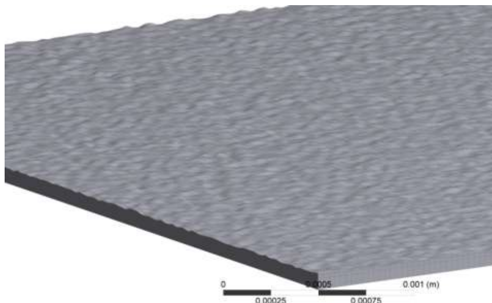
Рис. 9.38. Сеточная модель шероховатости с R_a=2.45 мкм (изометрия).
