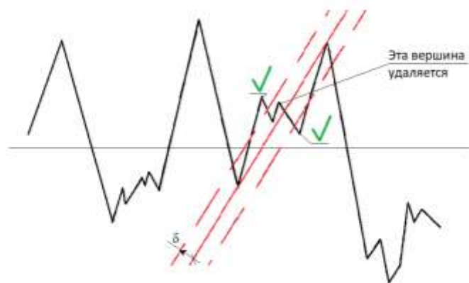
Рис.3.17. Схема используемого дополнительного способа сокращения точек.
