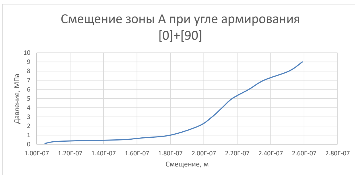
Рис.9.93 Величина смещение поверхности при угле армирования [0]+[90]
