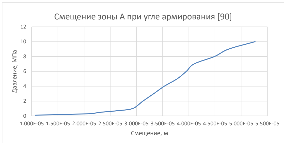
Рис.9.91 Величина смещение поверхности при угле армирования [90]
