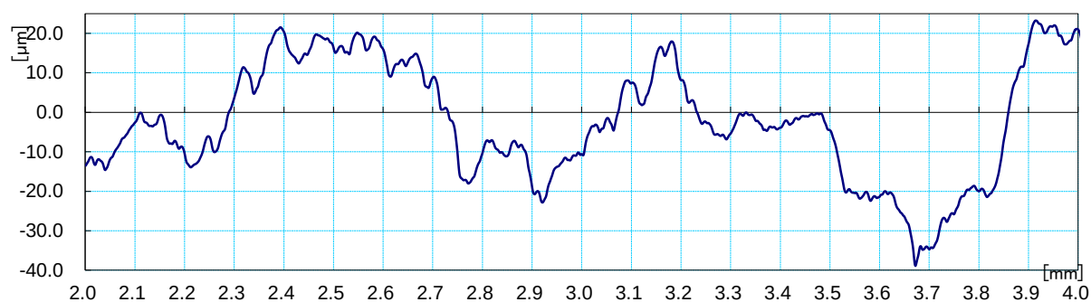
Рис.9.35. Шероховатость камеры сгорания на интервале 2мм.
