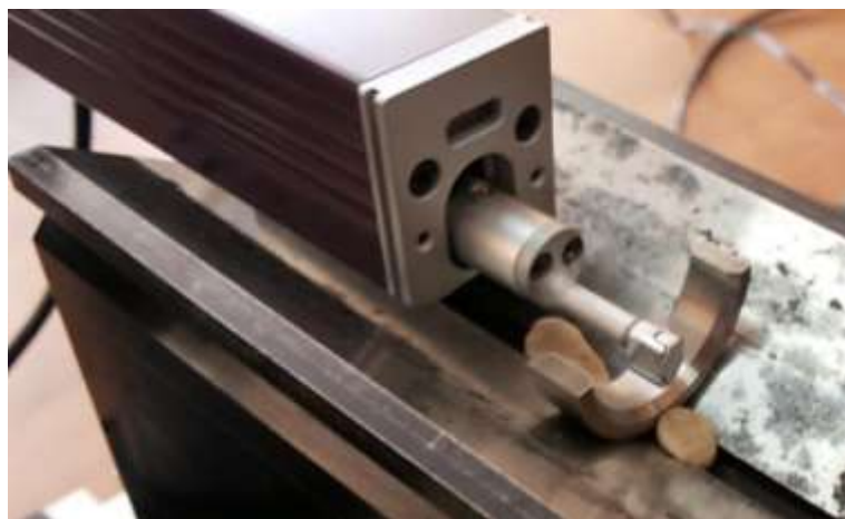
Рис.9.32. Установка переходного кольца в клиновом держателе.
