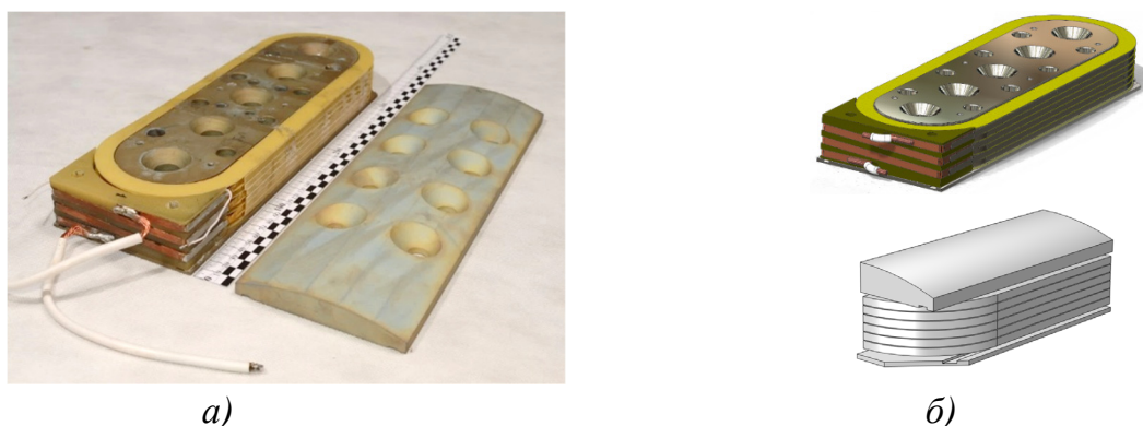
Рисунок 9 – Катушка из ВТСП ленты: а — экспериментальный образец; б — модель
