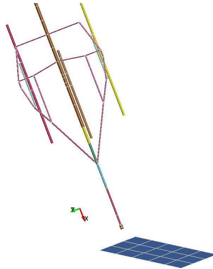
Рис. 15. Ориентация самолета относительно поверхности грунта в момент столкновения
