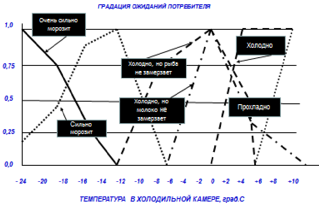
Рис. 3.22 Вид функций принадлежности параметра «Температура холодильной камеры» лингвистическим значениям ожиданий потребителя
