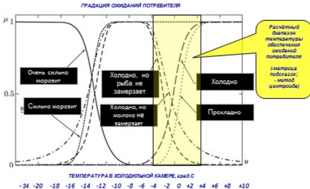
Рис. 3.23 Функции принадлежности параметра «Температура холодильной камеры» лингвистическим значениям ожиданий потребителя после применения матрицы подсказок
