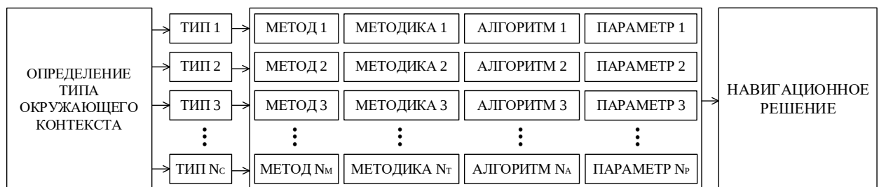
Рисунок 26 – Блок-схема разработанного подхода учета ОК по сигналам ГЛОНАСС открытого доступа с использованием алгоритмов машинного обучения
