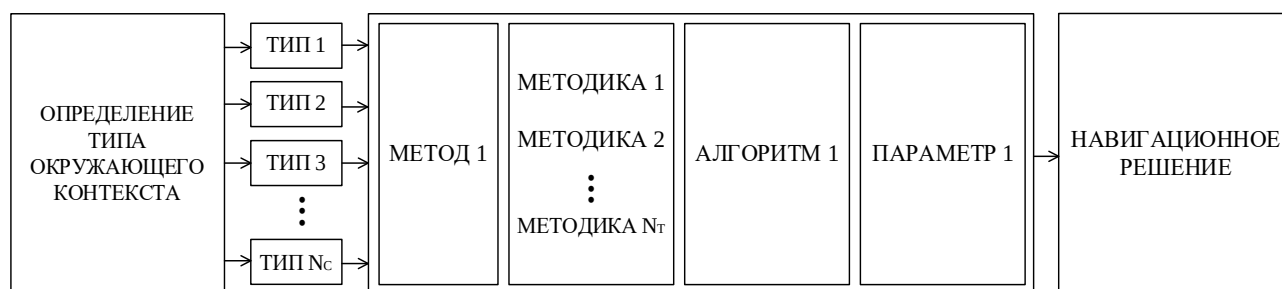
Рисунок 4 – Блок-схема существующей методики учета типа ОК по сигналам ГНСС с использованием методов машинного обучения
