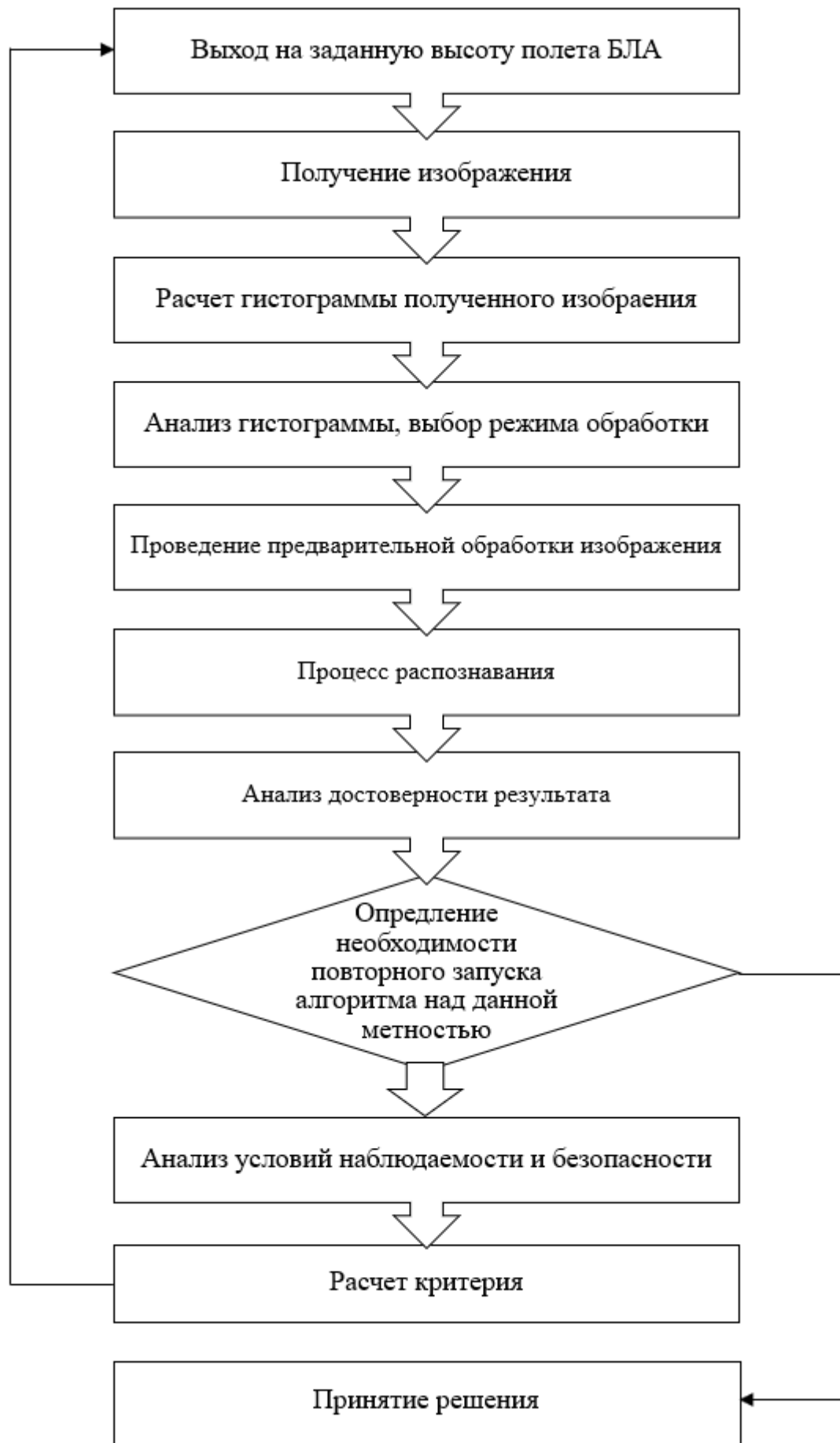
Рисунок. 2.34 - Схема работы адаптивного алгоритма
