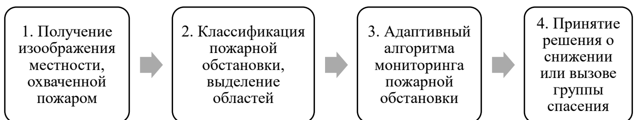
Рисунок. 2.33 - Общая схема работы алгоритма
