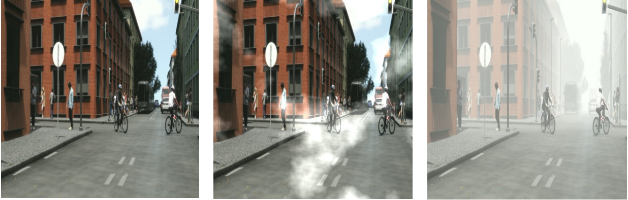
Рисунок. 2.14 - Слева-направо: оригинальное изображение, то же изображение с наложением шума Перлина, оригинальное изображение с добавлением смоделированного тумана с помощью карты глубины
