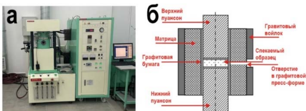
Рисунок 4 – Установка SPS-515S «Dr.Sinter LAB™»: а – общий вид установки; б – схематическое изображение графитовой пресс-формы.
