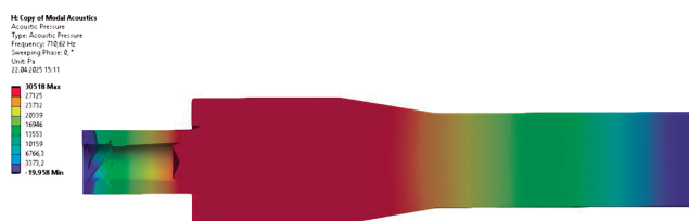
Рис. 8. Первая продольная мода с частотой 710 Гц
