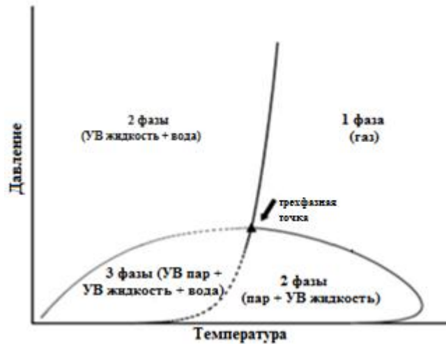
Рисунок 5. Фазовая диаграмма системы «пластовая углеводородная газоконденсатная смесь – вода»
