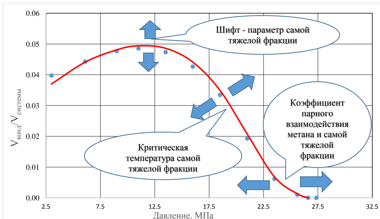
Рисунок 1. Влияние параметров уравнения состояния на кривую пластовых потерь насыщенного конденсата
