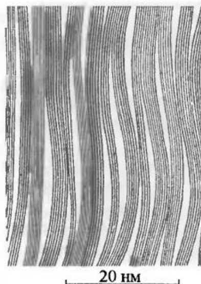
Рисунок 1.1 – Схема ленточной структуры УВ [2].
