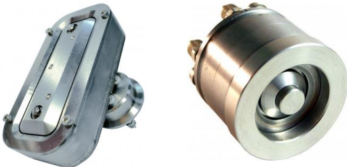
Рисунок 4.4 – Фото конфигураций УАС: Протяжной (слева) и круглый (справа) [80].
