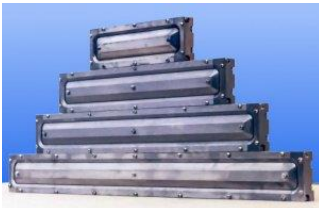
Рисунок 4.5 – Ионные источники линейного типа [80].
