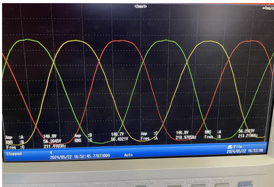
Рисунок 4.8 – Осциллограмма ЭДС холостого хода при температуре 20°C (экспериментальное значение)
