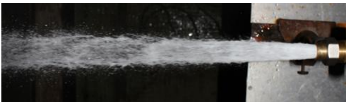
Рисунок 2.16 - Двухфазная газок капельная струя
