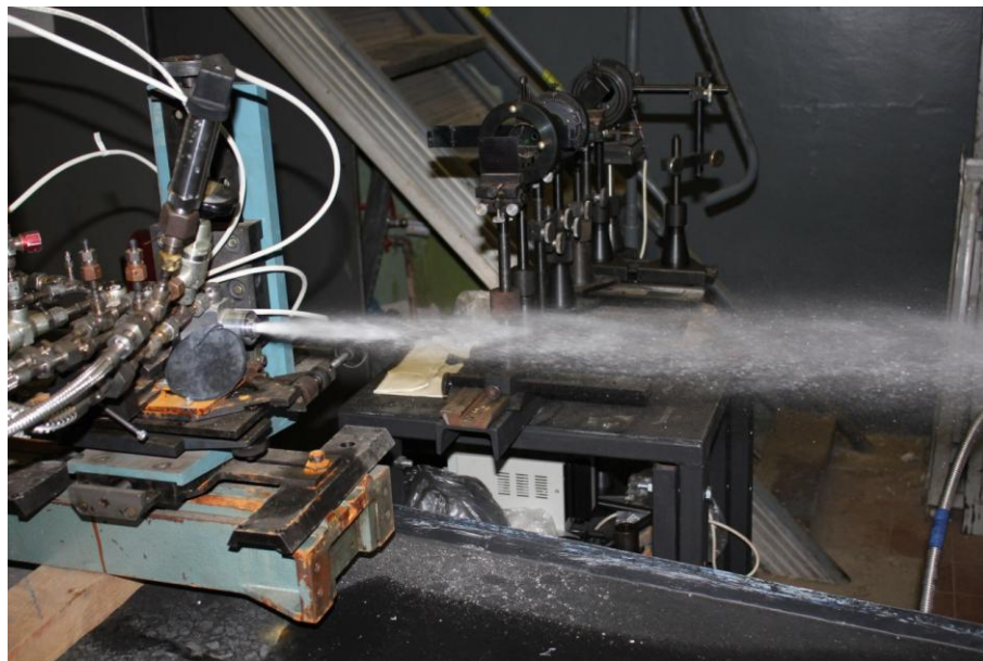
Рисунок 3.34 – Фотография работы сопла № 3 при P_{ж}=9,6 атм.
