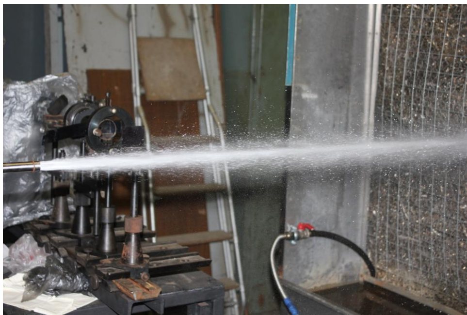
Рисунок 4.23 – Фотография газокпельной струи, истекающей из эжектора
