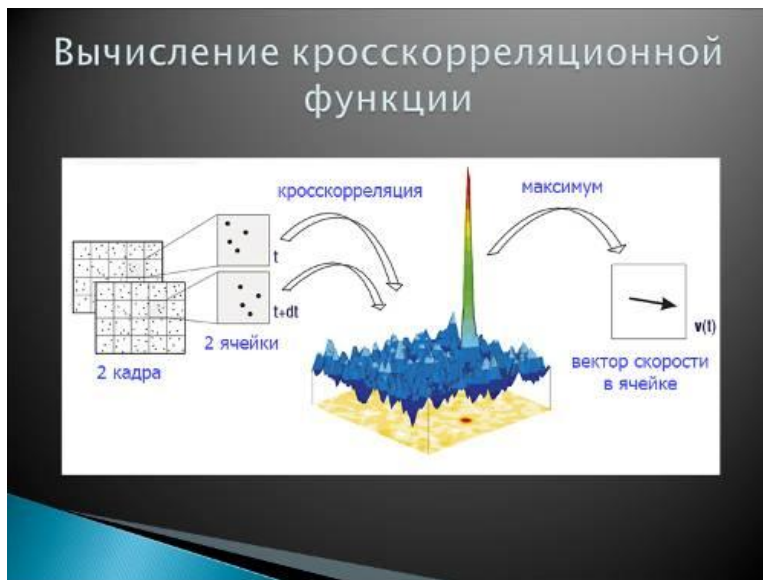
Рисунок 2.13 - Вычисление кросскорреляционной функции в ячейке
