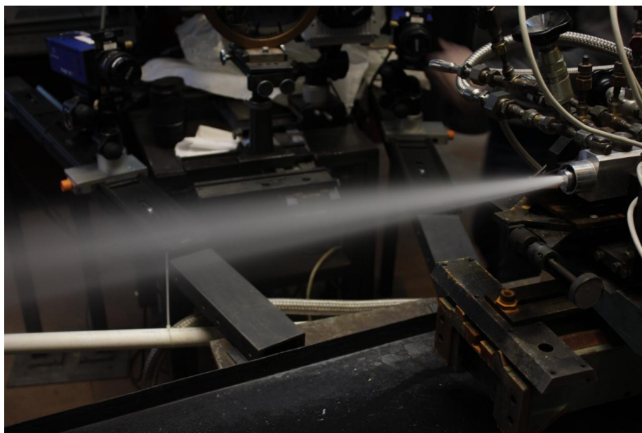
Рисунок 3.35 - Фотография работы сопла № 3 при P_{ж}=11,4 атм.
