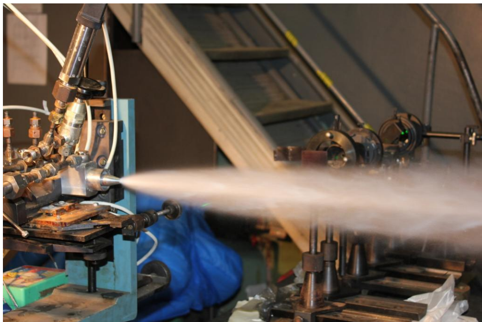
Рисунок 3.44 - Фотография газокапельной струи многоструйного сопла № 5 смесителя с двухфазным рабочим телом
