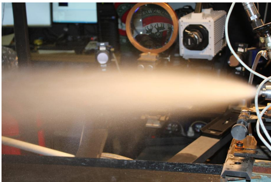
Рисунок 3.25 – Снимок двухфазной струи с внешним освещением
