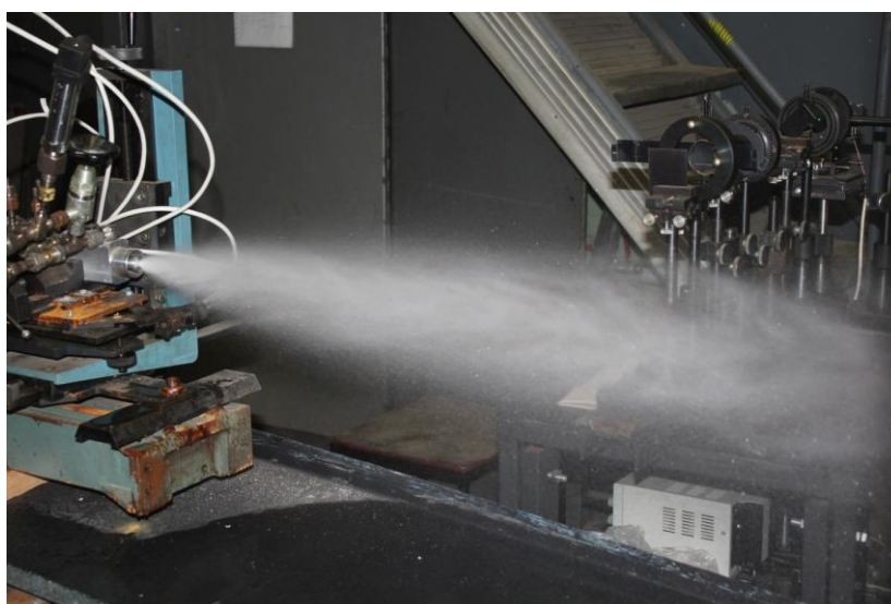
Рисунок 3.24 – Снимок двухфазной струи со вспышкой
