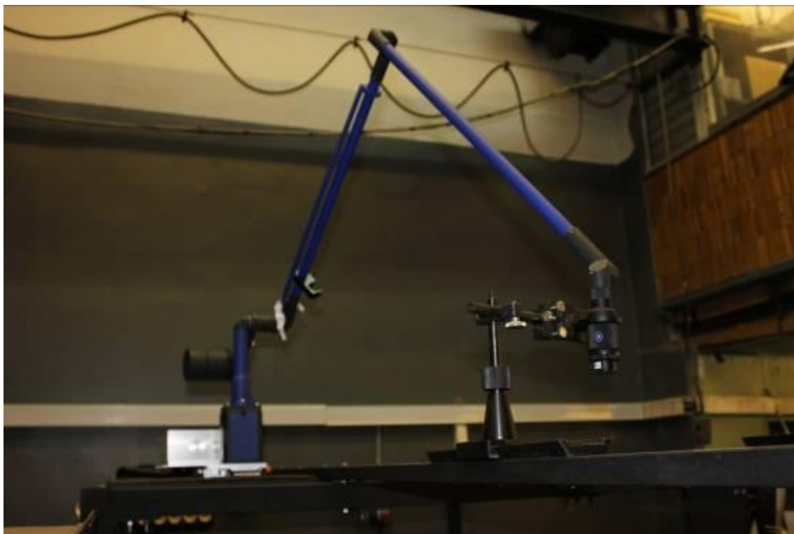
Рисунок 2.15 - PIV – лазер с оптической «рукой»
