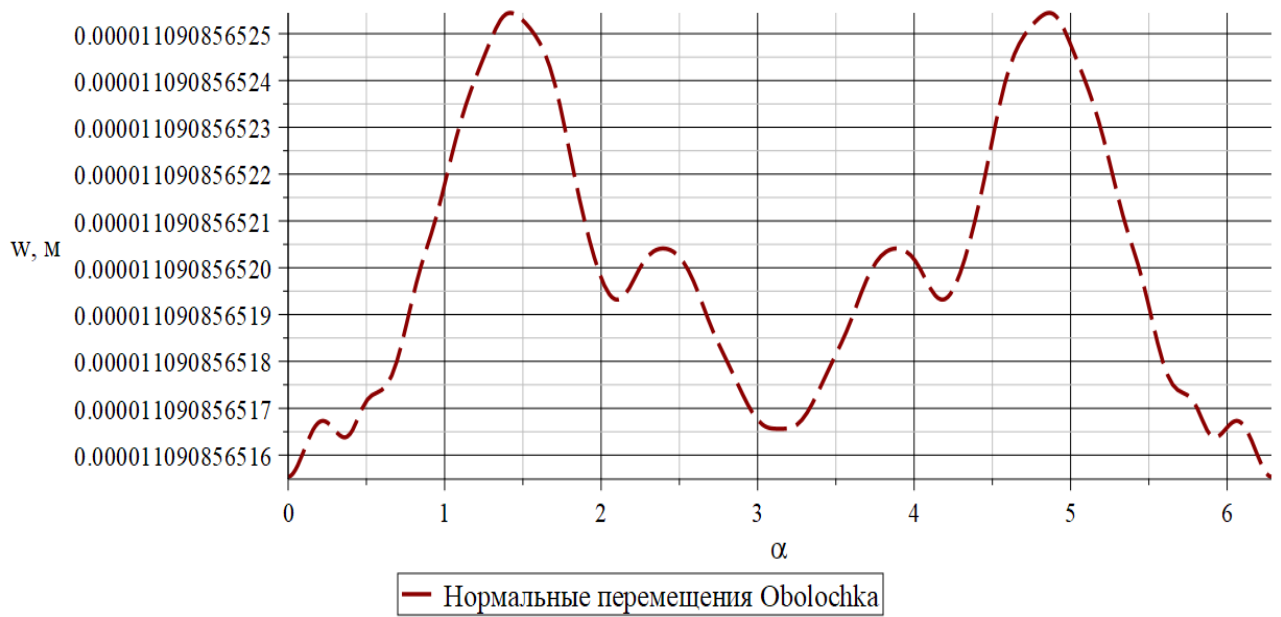
Рисунок 3.7 – График нормальных перемещений сегмента оболочки под воздействием цилиндрической гармонической волны
