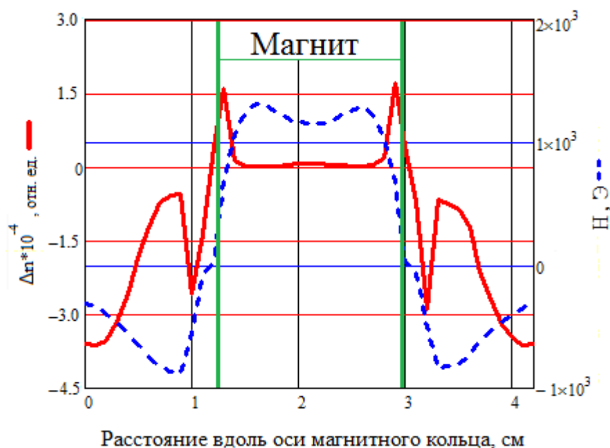
Рисунок 3 – Зависимость продольной составляющей напряженности магнитного поля (синий пунктир) и изменение показателя преломления активной среды (красная линия) в зависимости от положения вдоль оси кольцевого магнита из NdFeB 280/160. Зелёными линиями показаны границы торцов магнита.
