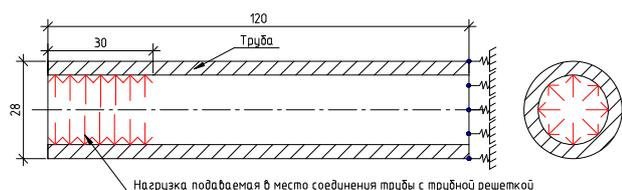
Рис. 7. Геометрическая модель трубы
