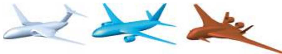
Рис. 3. Альтернативные интегральные компоновочные схемы для перспективных магистральных пассажирских самолетов
