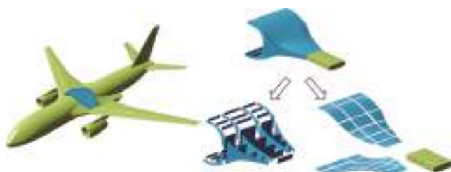
Рис. 4. Основные элементы композитной каркасной конструкции для интегральной компоновочной схемы
