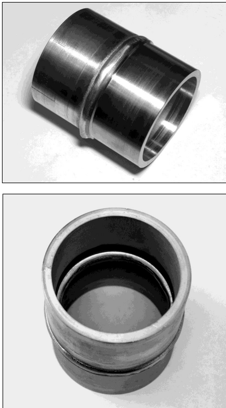
Рисунок 4.8 – Сварное соединение трубных заготовок переходников АМгЗ+ОТ4 диаметром 70 мм
