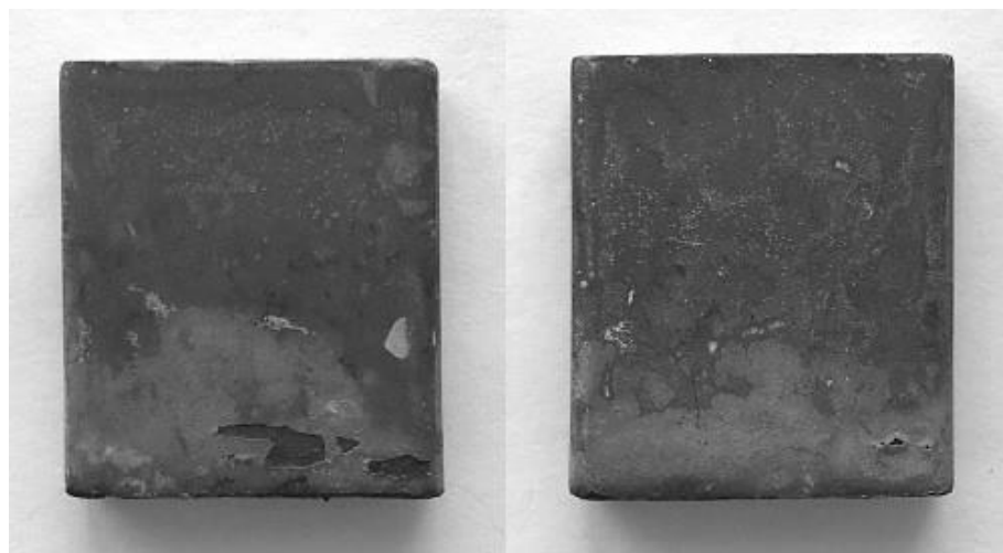
Рисунок 6.27 – Вид образца из сплава марки ЧС88У-ВИс нанесенной на поверхность системой покрытия \text{Ni-Co-Cr-Al-Y} / \text{ZrO}_2\text{-Y}_2\text{O}_3 / \text{Ni-Al} после 50 часов испытаний
