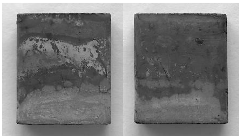
Рисунок 6.27 – Вид образца из сплава марки СЛЖС5-ВИ с нанесенной на поверхность системой покрытия \text{Ni-Co-Cr-Al-Y} / \text{ZrO}_2\text{-Y}_2\text{O}_3 / \text{Ni-Al} после 50 часов испытаний
