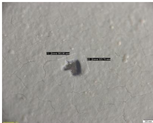
Рисунок 3.2 – Выплески материала покрытия на поверхности лопатки
