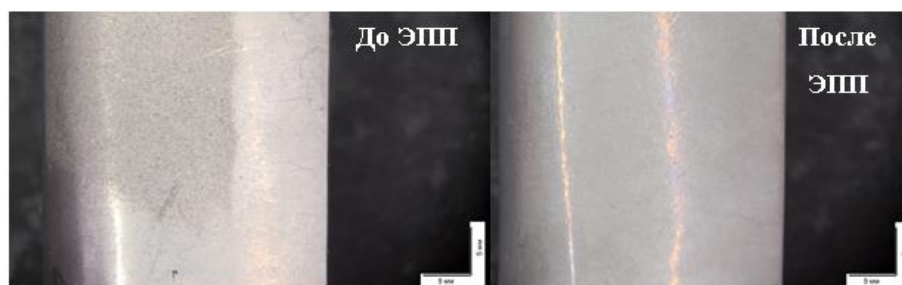
Рисунок 4.23 – Внешний вид лопатки до и после операции электролитно-плазменной полировки
