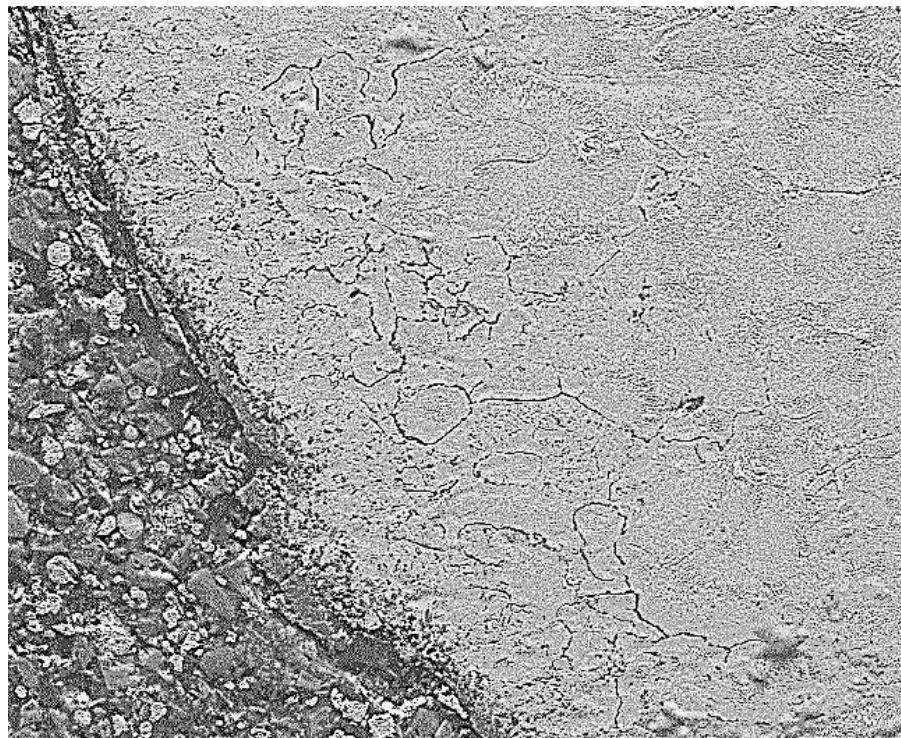
Рисунок 6.26 – Межкристаллитная коррозия сплава марки ЧС88У-ВИ в местах разрушения системы покрытия, \times 500
