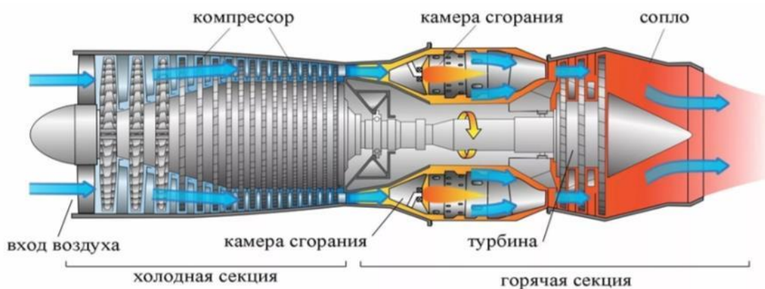
Рисунок 1.1 – Схема газотурбинного двигателя
