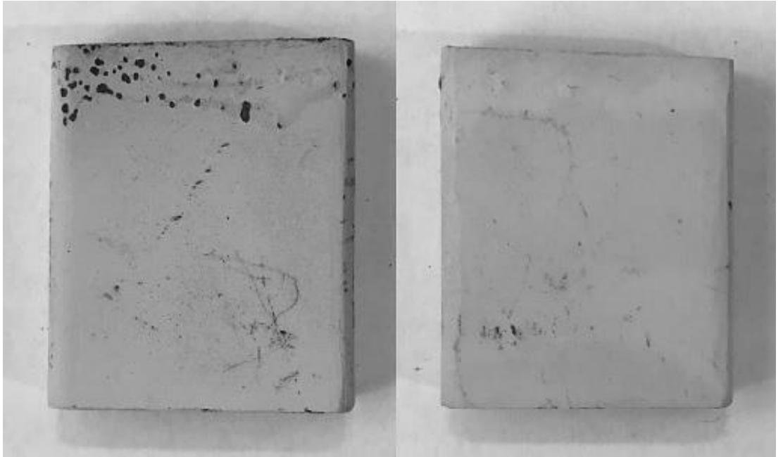
Рисунок 6.21 – Вид образца из сплава марки ЧС88У-ВИ с нанесенной на поверхность системой покрытия Ni-Co-Cr-Al-Y / ZrO 2 -Y 2 O 3 после 10 часов испытаний
