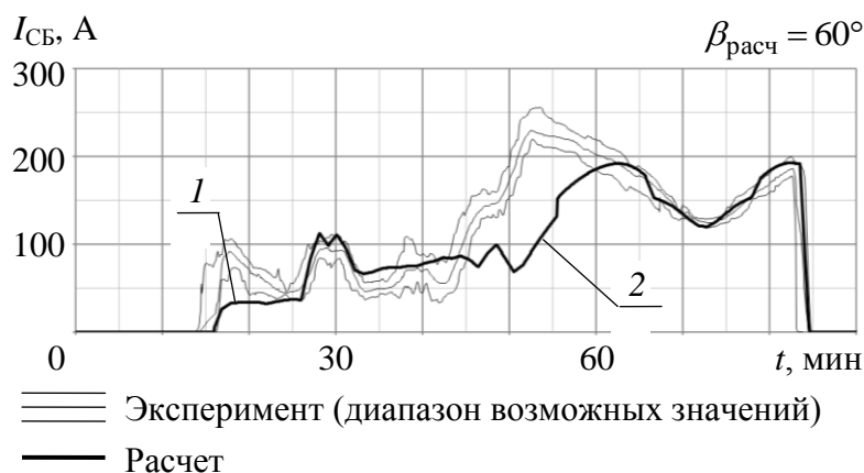
Рисунок 4.13 – Моментальный ток СБ СМ при \beta_{\text{расч}} = 60^\circ
