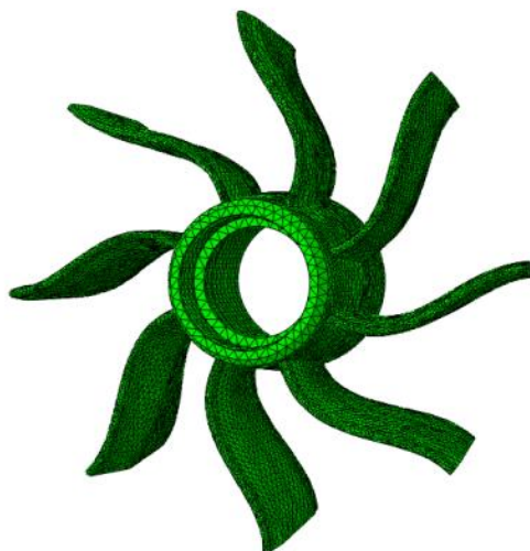
Рисунок 6. Форма колебаний пилонов(53 Гц)
