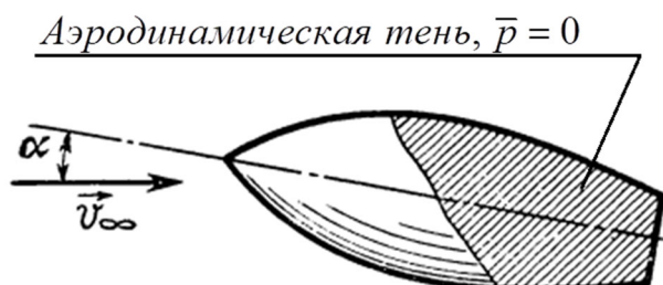
Рисунок 3.1 – Приблизённая схема обтекания тела потоком при M > 5 :
