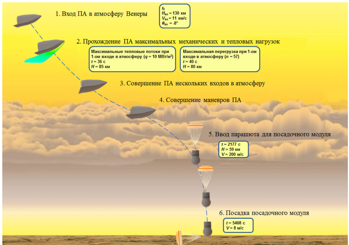
Рисунок 4.19 – Схема спуска ПА класса «несущий корпус» с использованием парашютной системы для спуска ПМ
