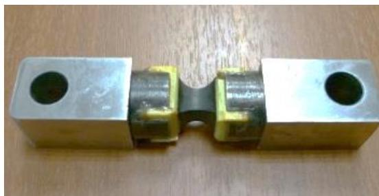
Рисунок 9. Соединение образца с нагружающими блоками
