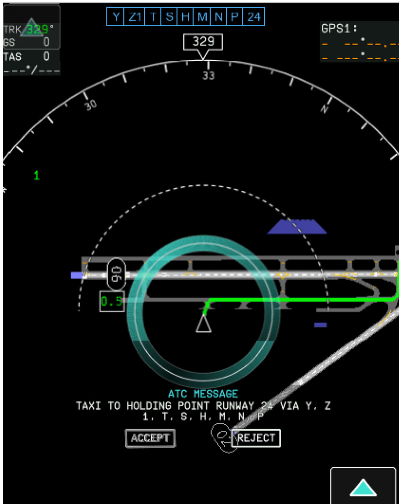
Рисунок 2.4 – Концепция индикации подтвержденного маршрута руления в кадре навигационного дисплея
