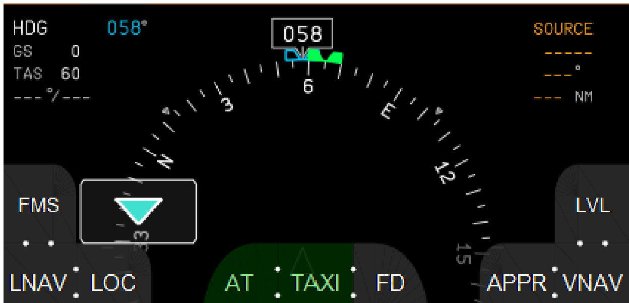
Рисунок 3.5 Включенный режим авторуления на кадре индикатора горизонтального положения
