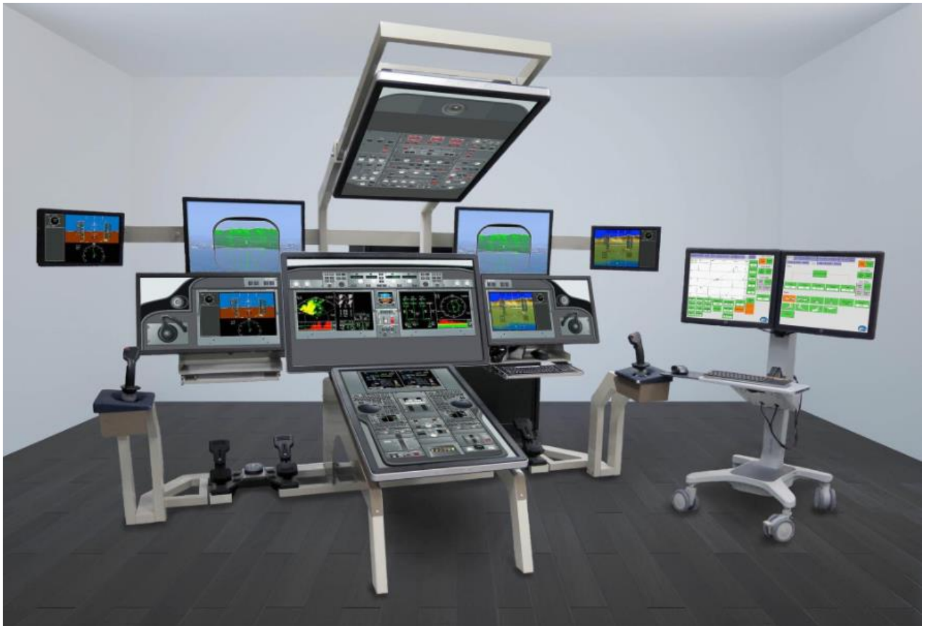
Рисунок 3.1 – Стенд прототипирования кабины экипажа МС-21
