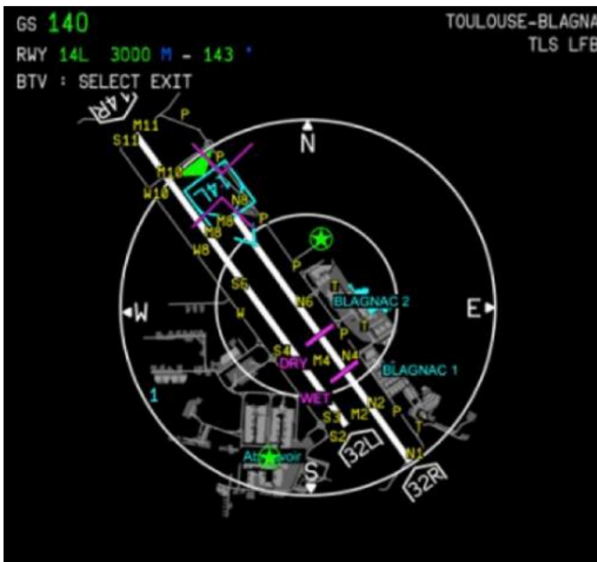
Рисунок 1.5 – Кадр системы предотвращения выкатывания за пределы ВПП на навигационном дисплее в ВС Airbus A350
