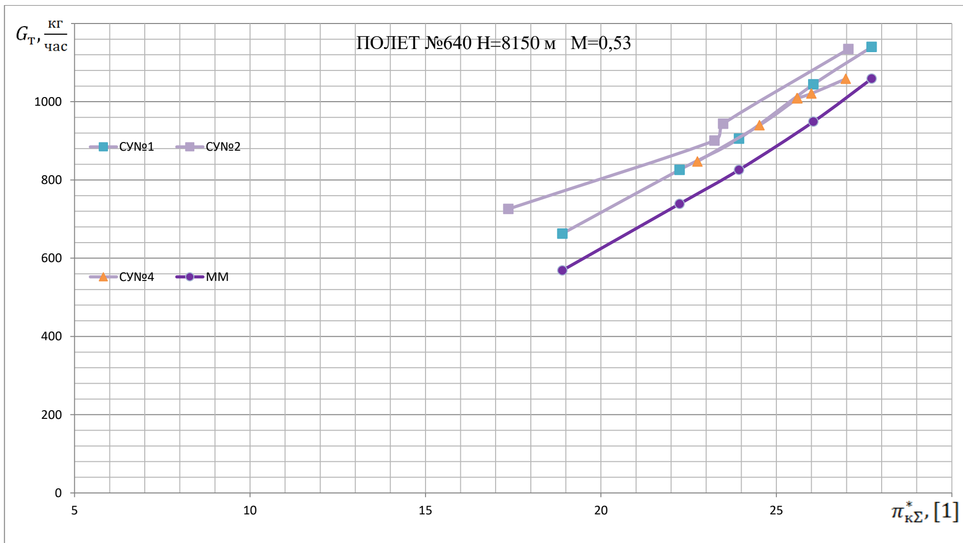
Рисунок Б.12 – Сравнение расходов топлива в КС СУ №1,2,4, измеренных в процессе летных испытаний (полет №640 от 31.10.12), с расходами топлива в КС, полученными по результатам расчета ММ ТВВД Д-27, на высоте H = 8150 м и при числе Маха M = 0,53 (полет №640 от 31.10.12)
