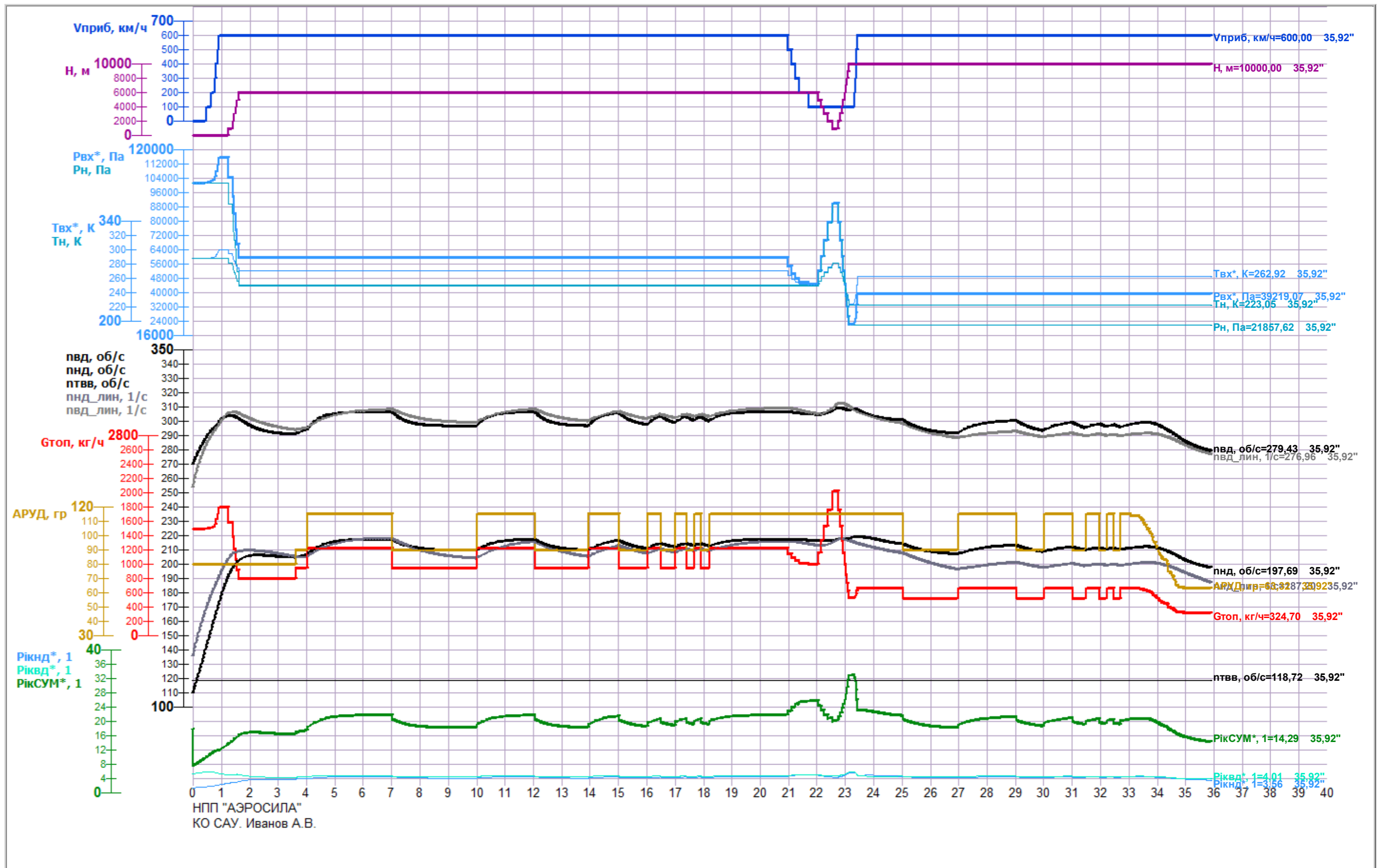
Рисунок 6.7 – Сравнение динамических характеристик нелинейной поузловой ММ ТВВД Д-27 с динамическими характеристиками КЛДМ Д-27
