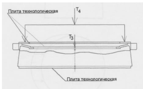
Рис. 12 Совместное действие эксплуатационных сил T_3 и T_4
