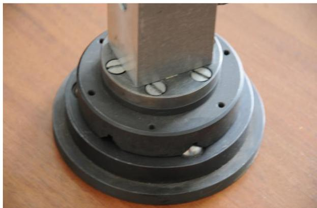
*Установка образца с верхней частью кинематического устройства на нижнюю часть*
