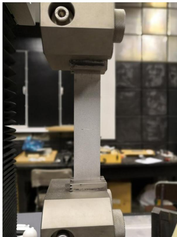
Рисунок 2.17 – Образец в захватах испытательной машины *walter + bai ag LFM-L 22*
