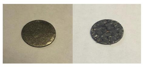
Рисунок 7 — Экспериментальный образец для исследования внеплоскостных температуропроводности и теплопроводности
