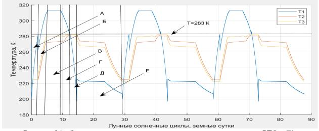
Рисунок 24 — Зависимость температуры теплоносителя на выходе из PTO — T1, температуры рабочего вещества 16 — последнего элемента деления на узлы TA — T2, температуры теплоносителя на выходе из TA — T3 от времени лунных суток
