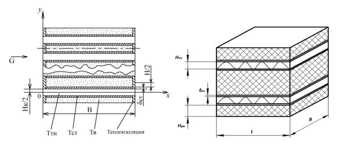
Рисунок 12 – Расчетная схема ТА
