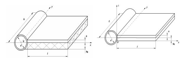
Рисунок 3 — Расчетная схема аналитической Рисунок 4 — Расчетная схема трехмерной модели двухмерной модели гибридного РТО гибридного РТО
