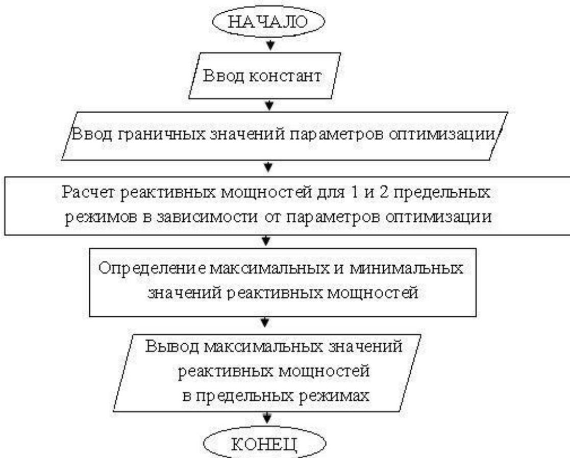
Рис. 6- Блок-схема алгоритма оптимизации параметров СУ
