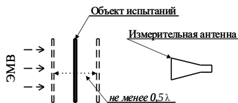
Рисунок 6 — Расположение обтекателя в процессе измерения
