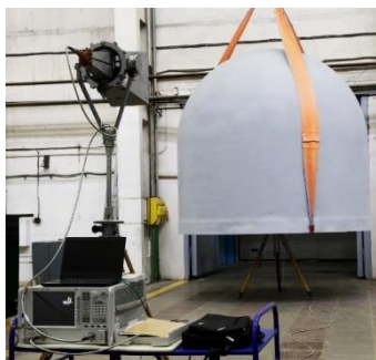
Рисунок 17 — Рабочее место проведения дефектоскопии РПУ
