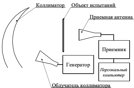
Рисунок 3 — Схема рабочего места в БЭК с коллиматором
