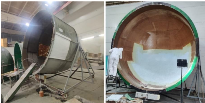
Рисунок 21 — Технологическая матрица для изготовления обтекателя №2
