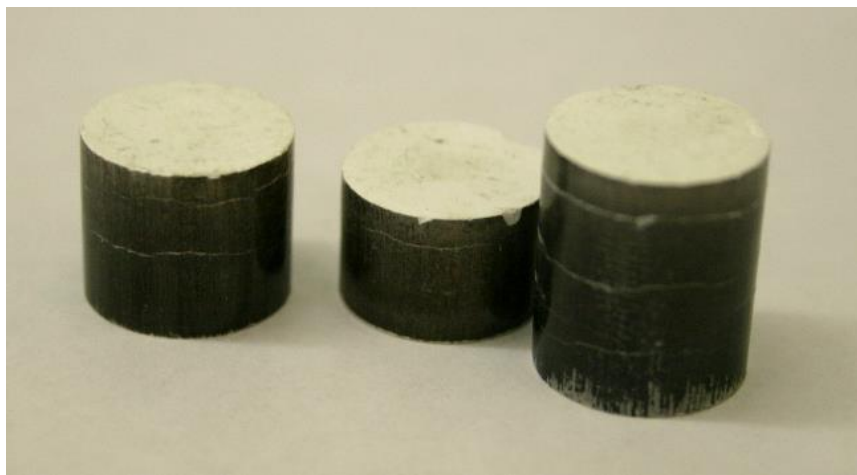
Рисунок 4.3 – Вид образцов при перепрессовке (тотальные трещины)
