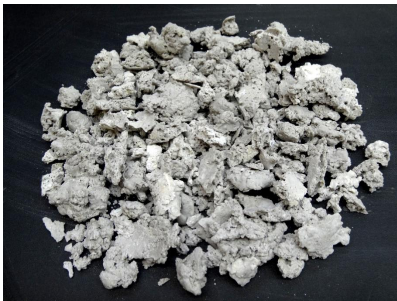
Рисунок 3.1 – Осадок после химического диспергирования сплава Al-Si (12%масс.)
