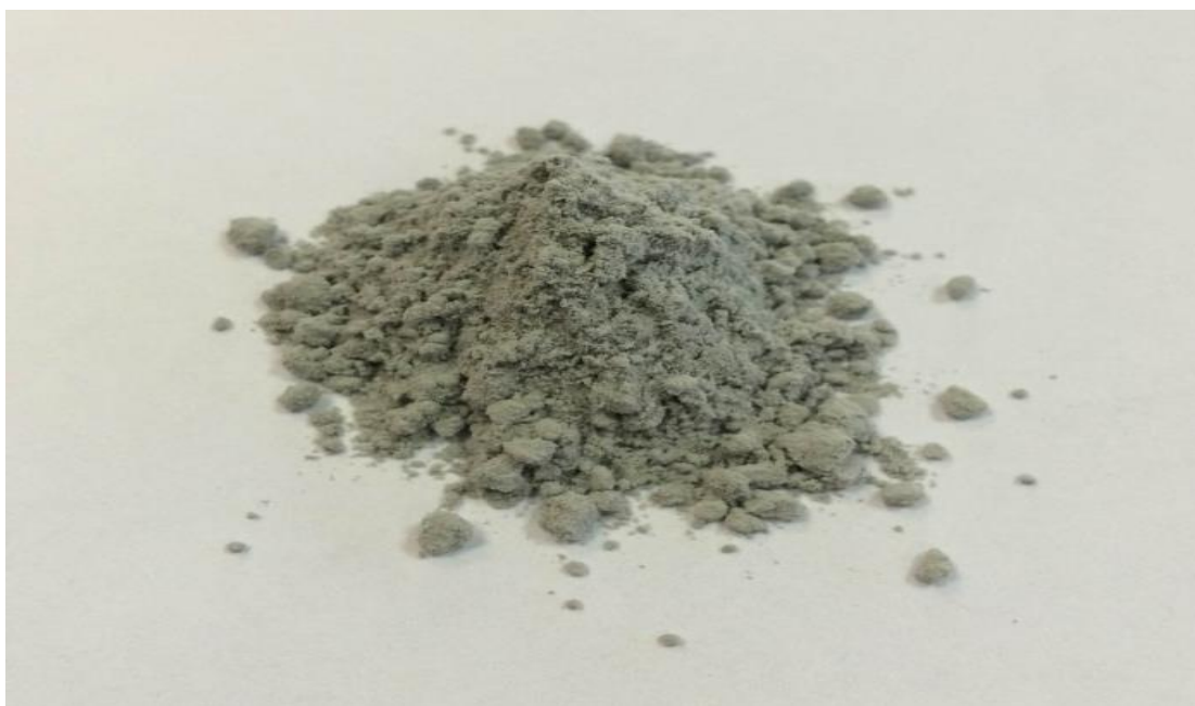
Рисунок 3.12 – Вид порошка после химического диспергирования Al-Mo.
