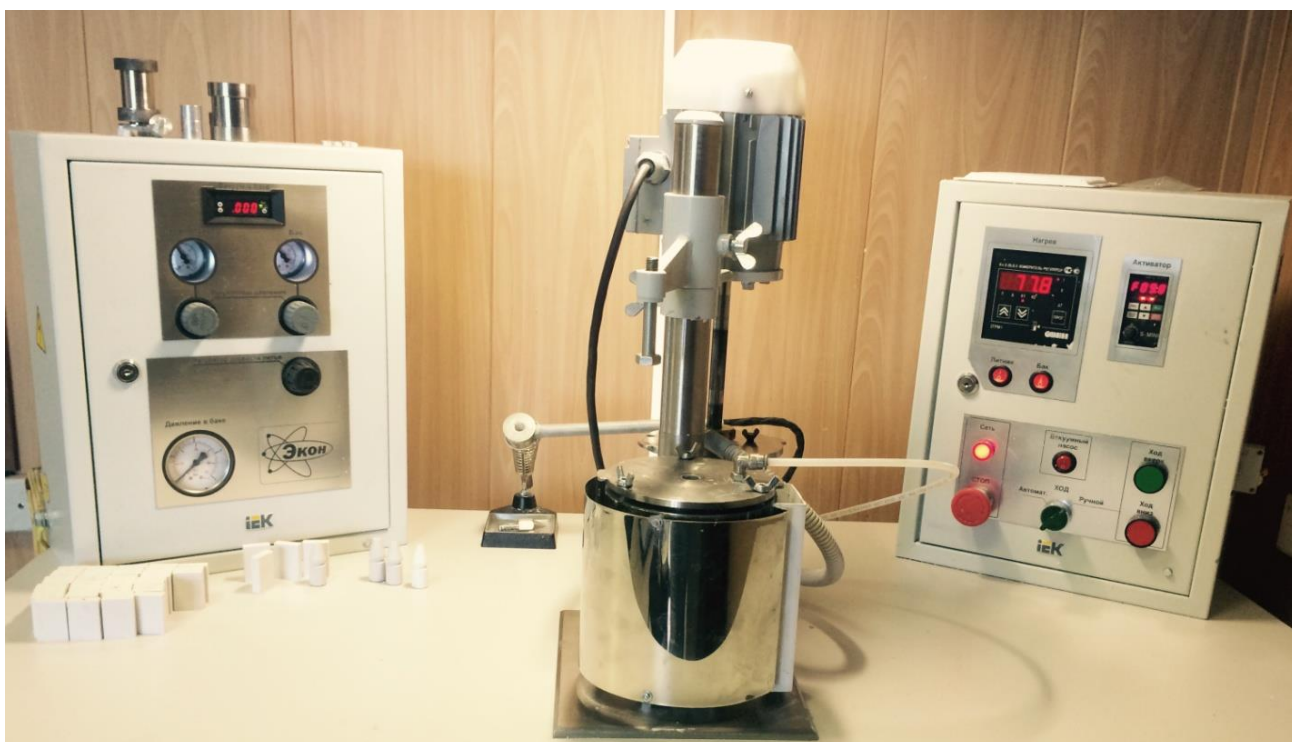
Рисунок 4.9 – Установка для горячего шликерного литья под давлением
