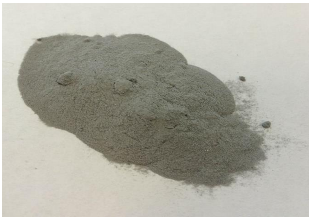
Рисунок 3.32 – Вид порошка после химического диспергирования сплава Al-Zr.
