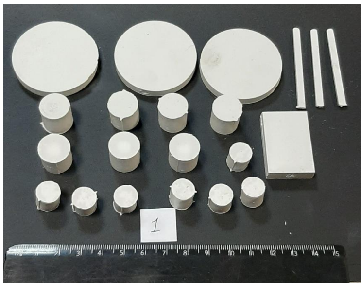
Рисунок 4.10 – Отформованные образцы из порошка АК12
