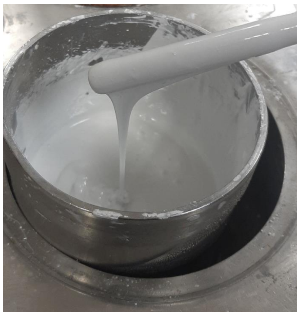
Рисунок 4.7 – Внешний вид шликера при приготовлении на водяной бане
