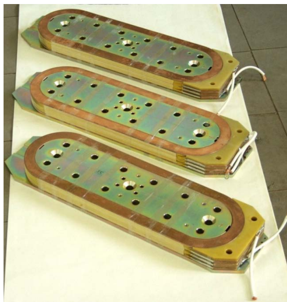
Рисунок 1.22 — Катушки возбуждения на основе ВТСП лент 2-го поколения
