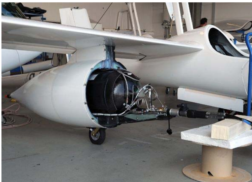
Рисунок 1.3 – Баки с водородом ПЭС Antares DLR-H2
