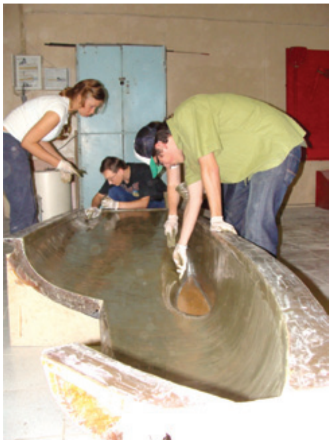
Рис. 3. Матрица фюзеляжа. Проект двухместного самолета ресурсного центра МАИ кафедры Инженерной графики. Магистратура по Авиастроению (магистерская программа по компьютерному инжинирингу)
