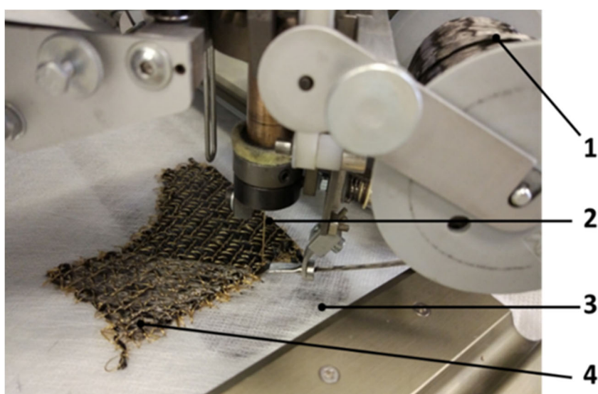
Рисунок 1 – Автоматизированная направленная нашивка углеродного ровинга на водорастворимую подложку:
