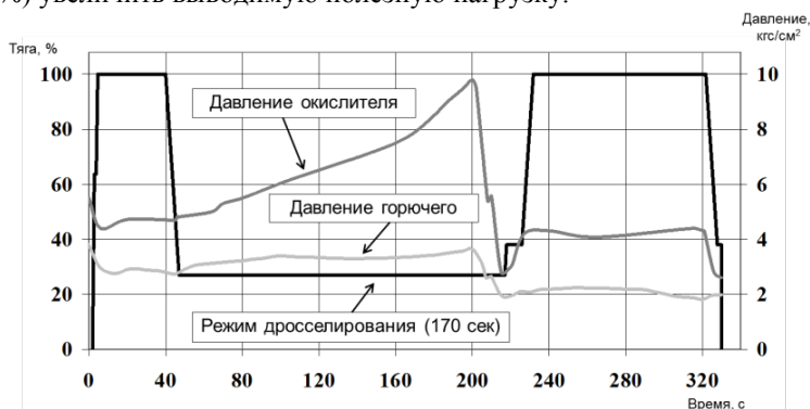
Рисунок 1. Циклограмма работы двигателя центрального блока РН «Ангара-А5» и изменение входных давлений компонентов топлива
