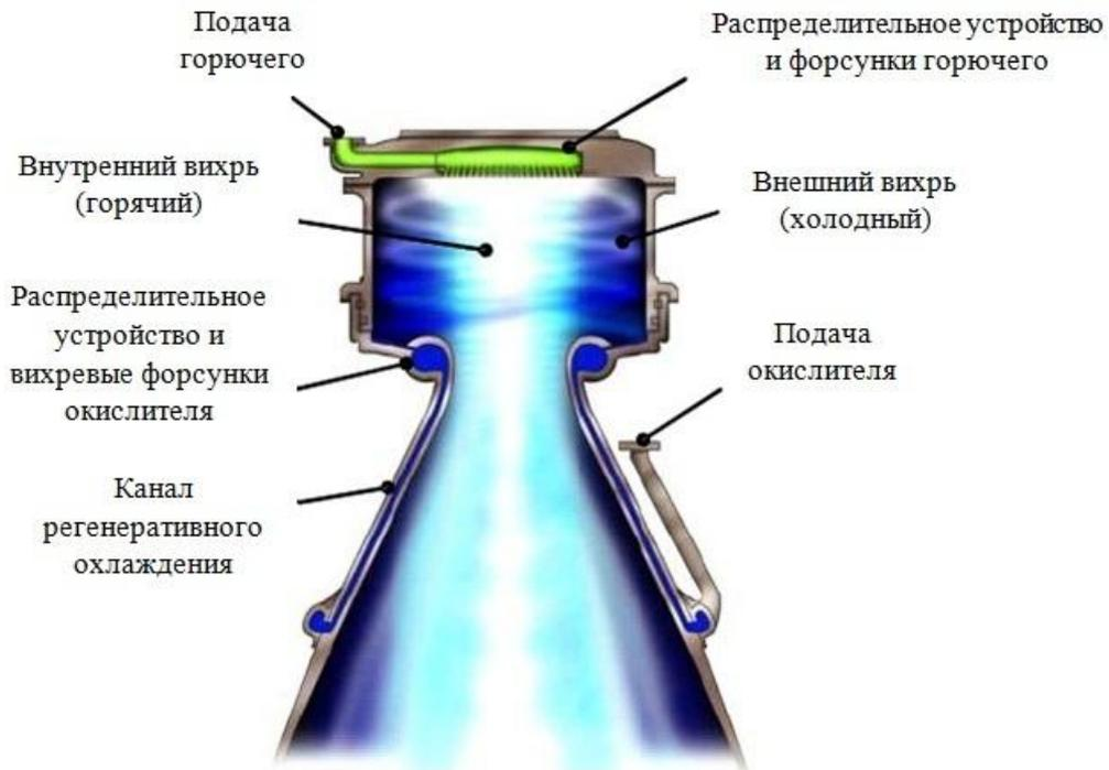
Рисунок 6. РД с вихревым охлаждением [11]
