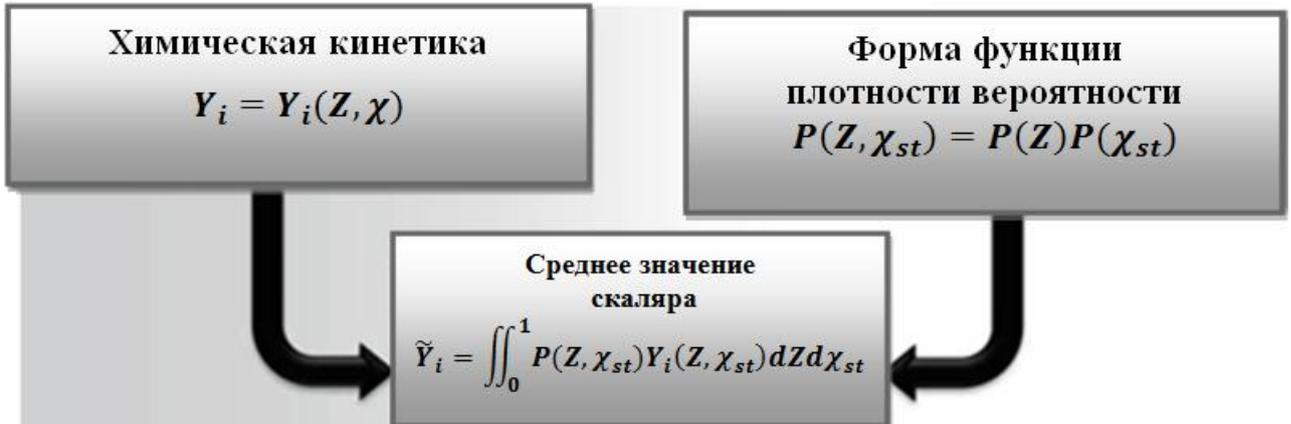
Рисунок 38. Схема расчета средних значений концентраций компонентов
