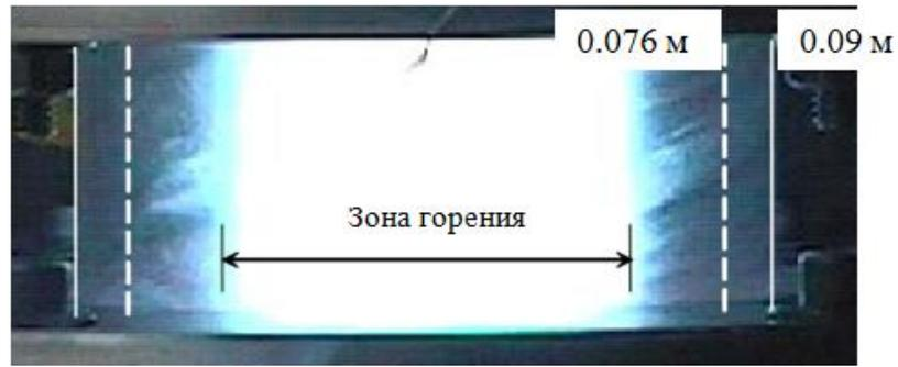
*Рисунок 7. Фотография зоны горения, ограниченной внутренним вихрем [11]*
