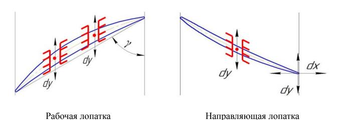
Рисунок 3 – Схема изменения формы средней линии профиля лопатки
