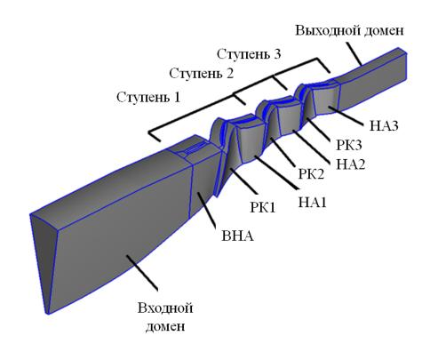
Рисунок 5 – Геометрическая модель расчётной области КНД
