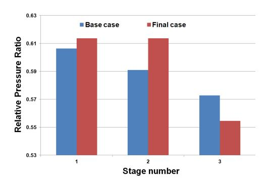
Рисунок 22 - Изменение относительной величины степени сжатия ступеней КНД в результате оптимизации
