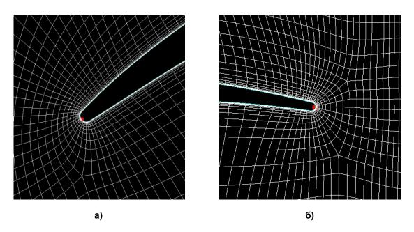
Рисунок 7 - Сетка конечных объемов «тяжелой» численной модели вблизи входной (а) и выходной кромок (б) лопаток компрессора
