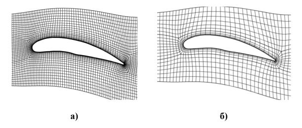
Рисунок 8 - Сравнительное изображение сеток конечных объемов "тяжелой" (а) и "легкой" (б) моделей
