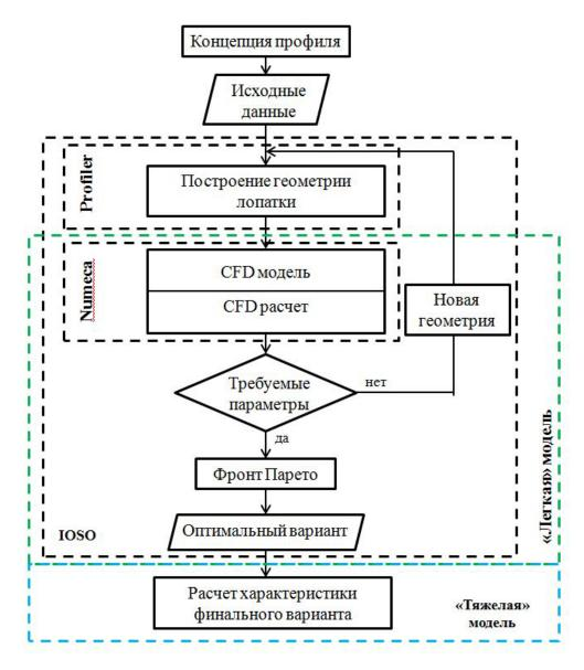
Рисунок 10 - Алгоритм поиска оптимальной формы лопаток КНД с использованием программного комплекса *IOSO*
