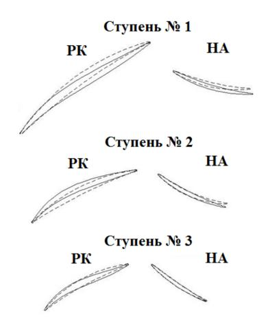
Рисунок 16 - Сопоставление форм профилей лопаток в среднем сечении исходного (пунктир) и модернизированного (сплошная линия) компрессора
