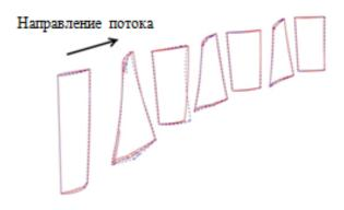
Рисунок 15 - Сопоставление форм лопаток исходного (пунктир) и модернизированного (сплошная линия) компрессора
