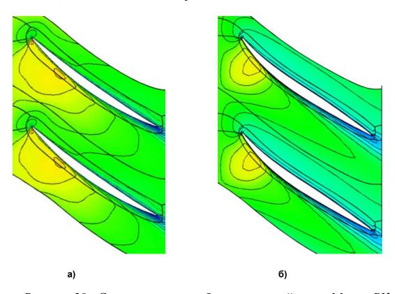
Рисунок 20 - Сравнительное изображение полей чисел Маха в РК первой ступени исходного (а) и оптимизированного (б) компрессоров
