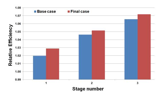
Рисунок 21 - Изменение относительной величины КПД ступеней КНД в результате оптимизации
