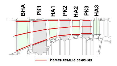
Рисунок 12 - Положение сечений лопаток, изменяемых в ходе оптимизации
