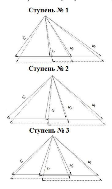
Рисунок 17 - Сопоставление планов скоростей в среднем сечении исходного (пунктир) и модернизированного (сплошная линия) компрессора
