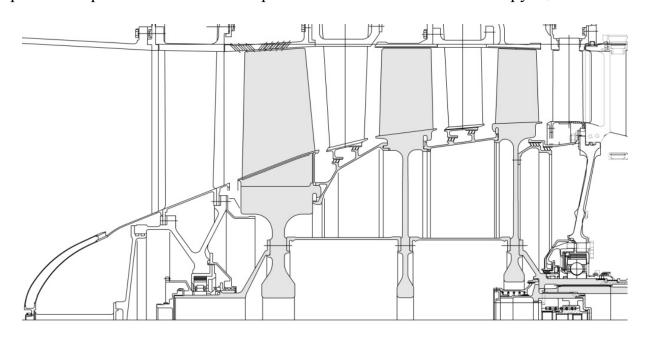
Рисунок 2 – Модернизируемый компрессор низкого давления
