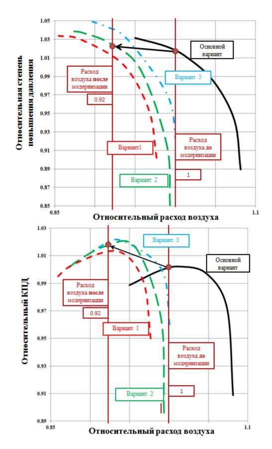
Рисунок 14 - Сравнение относительных характеристик выбранных вариантов КНД с характеристикой исходного компрессора
