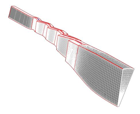
Рисунок 6 — Сетка конечных элементов "тяжелой" численной модели исследуемого компрессора
