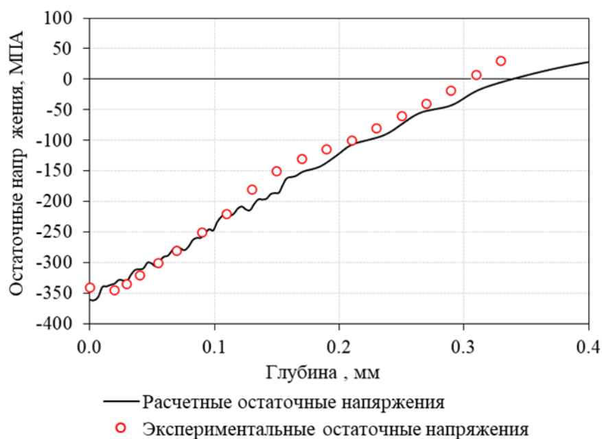
Рисунок 4.21 – Сравнение остаточных напряжений, наведенных в экспериментальных образцах и в расчетной модели
