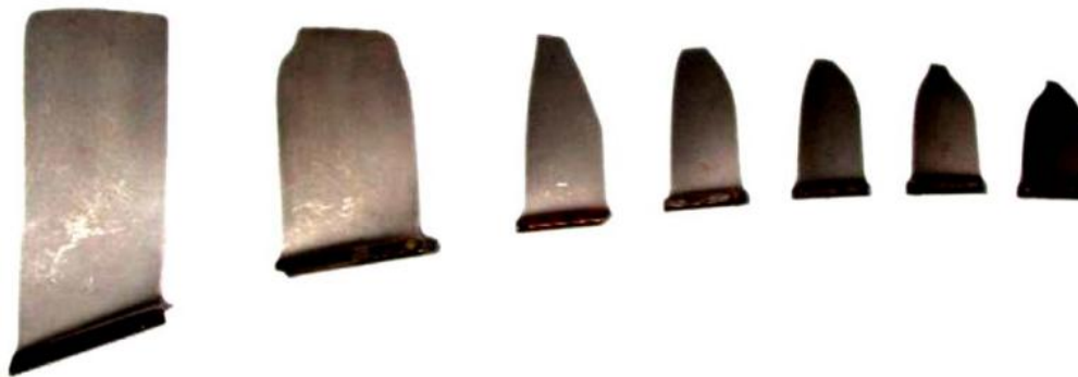
Рисунок 1.5 – Общий вид рабочих лопаток компрессора ГТД с эрозионным износом со 2-ой по 8-ую ступени (наработка 128 часов) [3]
