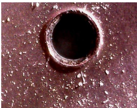
Рис. 01. Буртик и подъем фольги на выходе из отверстия (съемка сделана в косом свете)
