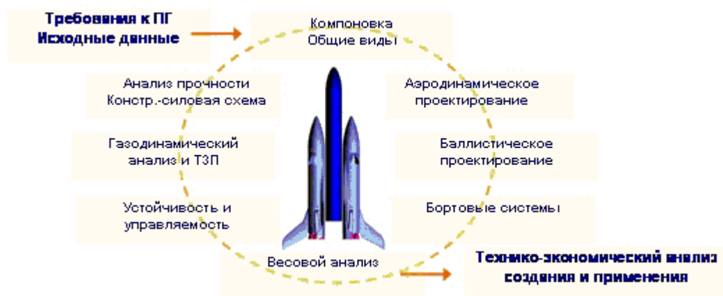
Рис. 1. Полный цикл проектирования многоразовой транспортной космической системы.
