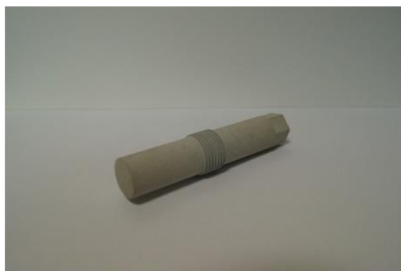
Рис.5.12. Болт (а) и гайка (б) с МДО
