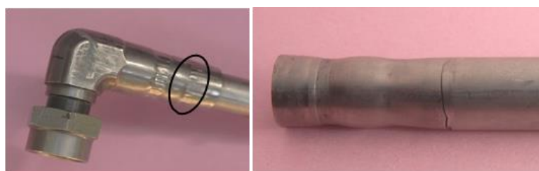
Рис.1.11 Обжимной концевой фитинг гидравлической системы с трещиной в трубопроводе под фитингом (удален) [8]
