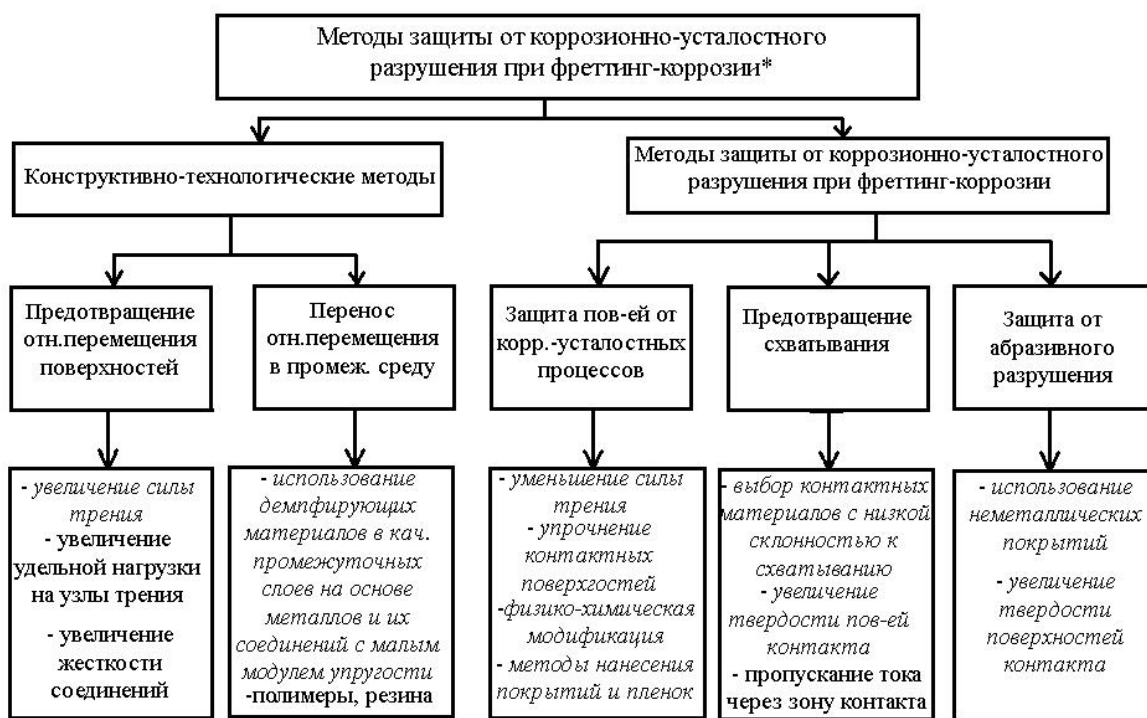
Рис. 1.17. Основные методы защиты от повреждений при фреттинг-коррозии [1]
