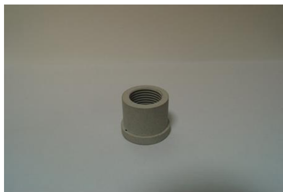
Рис.5.12. Болт (а) и гайка (б) с МДО
