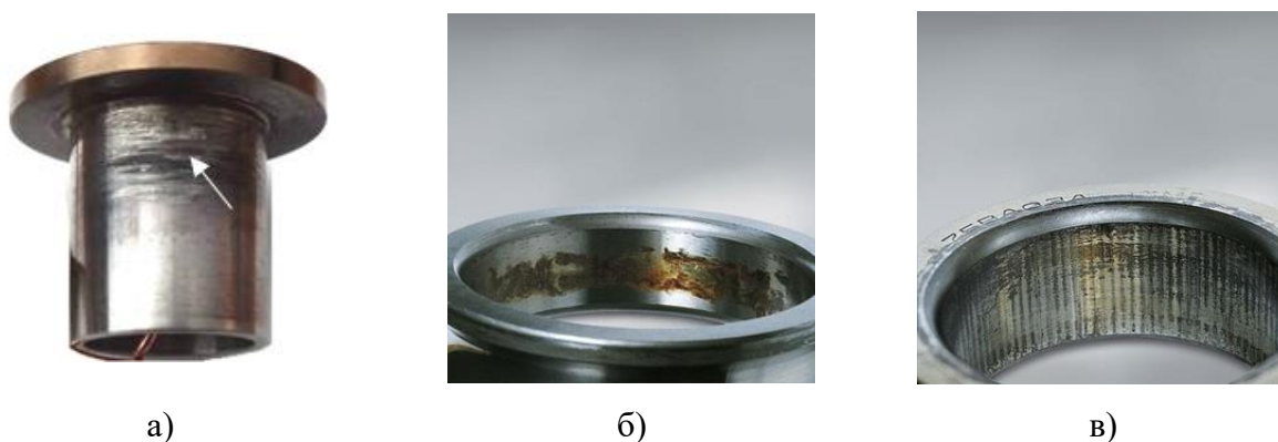
Рис.1.13. Примеры фреттинг-изнашивания колец подшипников [8].
