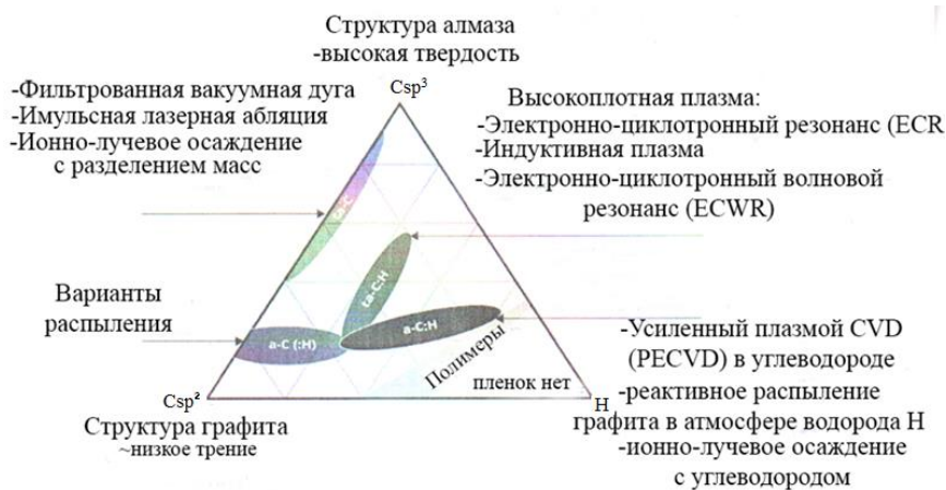
Рис. 1.18. Фазовая диаграмма формирования покрытий на базе DLC [24]
