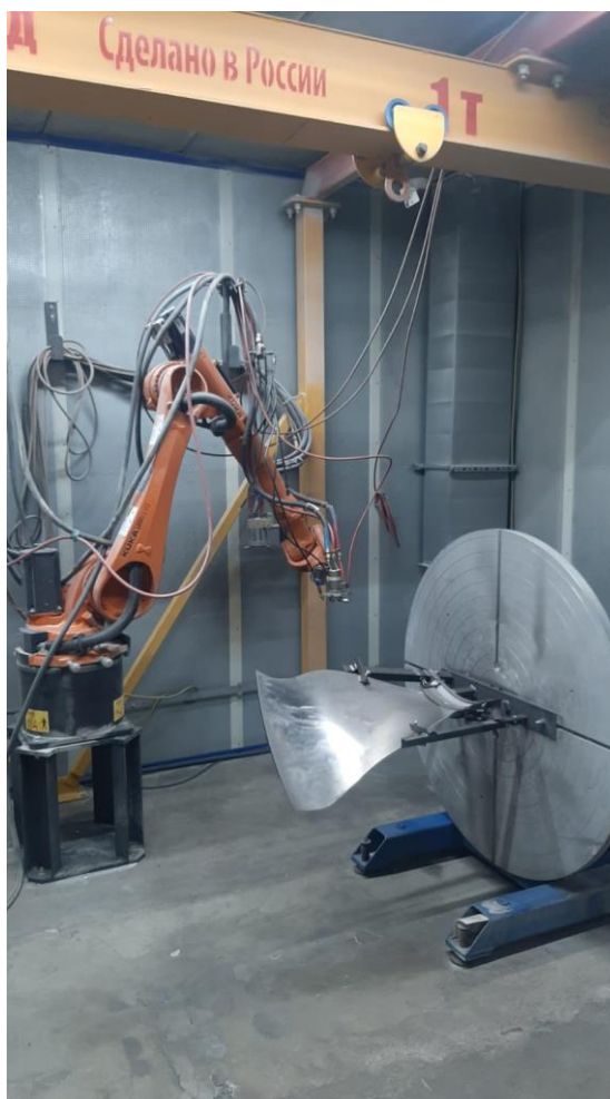
Рис. 5.5. Вентиляторная лопатка на установке атмосферного плазменного пыления.
