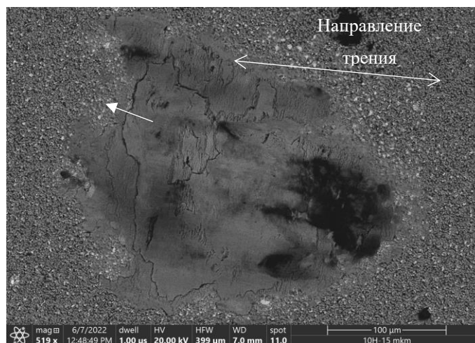
Рис. 4.14. Изображения повреждения покрытия TiN/Pb, полученным при трении с ШХ-15 в режимах 15 мкм, 10 Н, полученные на электронном микроскопе.
