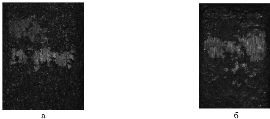
Рис. 4.39. Изображение пятен износа покрытия NiAl+CuNiIn+Ni[Cg]: а – 0,125мм; б – 0,325 мм
