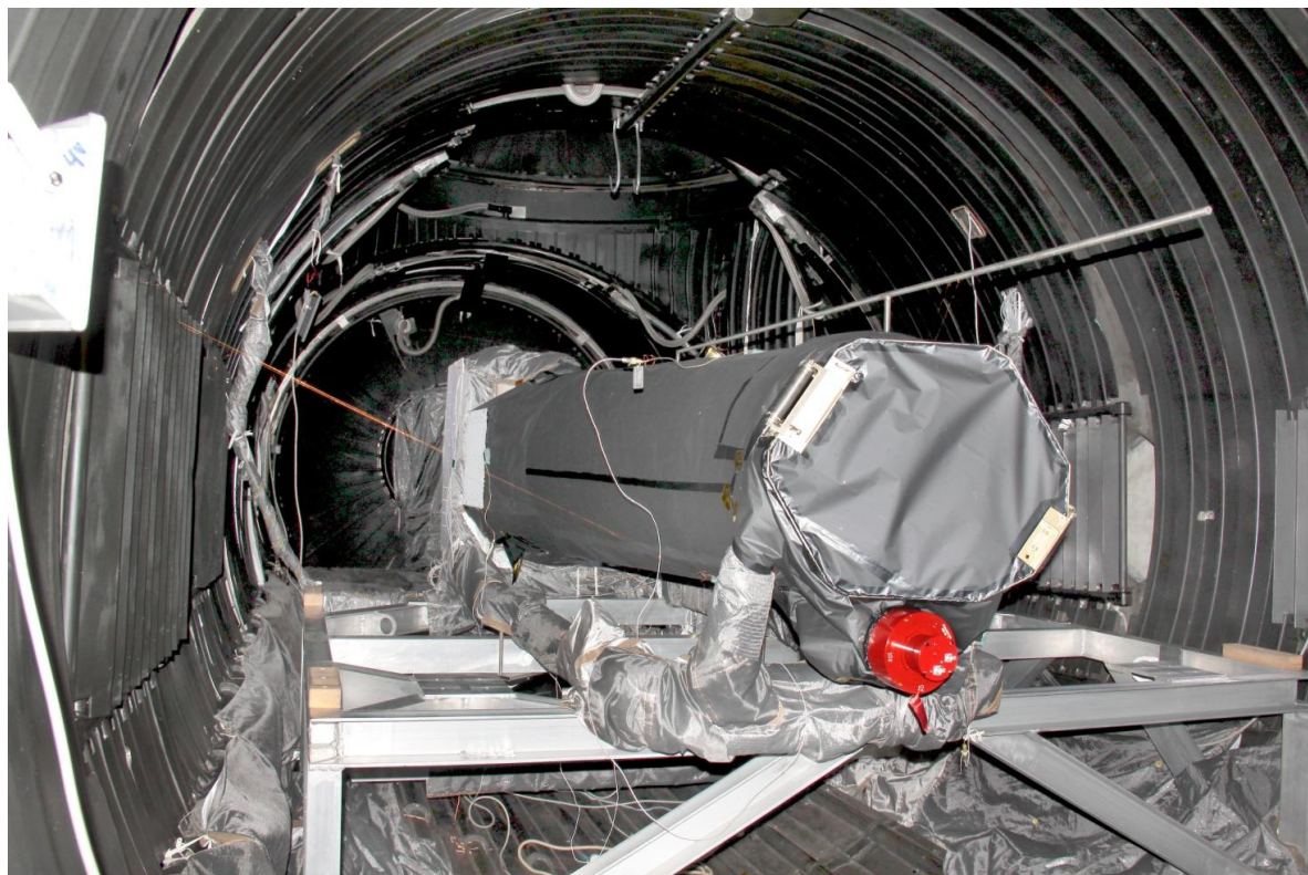
Рис. 5.2.21. Летный образец ART-ХС внутри термовакуумной камеры
