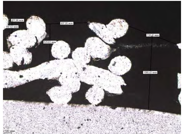
Рисунок 4.2. Схематическое изображение измерения открытых пор в покрытии
