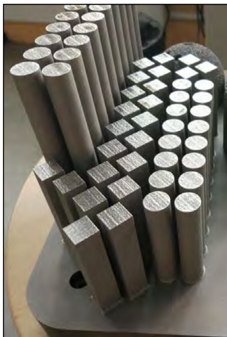
Рисунок. 2.1. Внешний вид образцов, полученных методом СЛС
