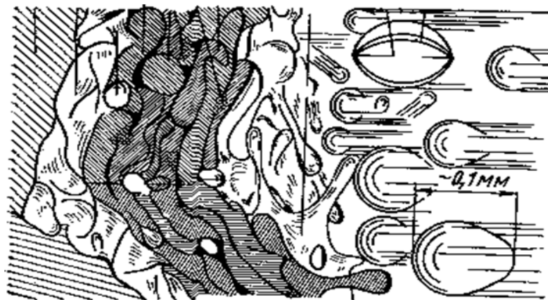
Рисунок 1.4 – Процесс нанесения покрытия (плазменной, газопламенной струей) [40].
