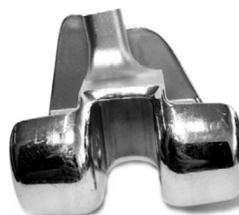
Рисунок. 5.8. Внешний вид мышцелки эндопротеза коленного сустава после механической обработки и полировки
