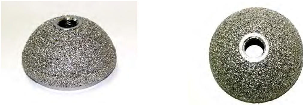
Рис. 5.1. Внешний вид чаши с покрытием, полученным методом ПЛНМ
