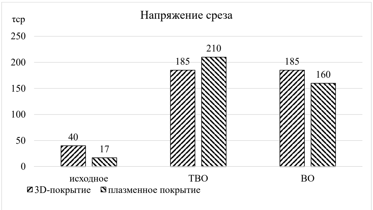
Рисунок 4.17. Адгезионная прочность 3D и плазменного покрытий в исходном состоянии и после термоводородной обработки и вакуумного отжига
