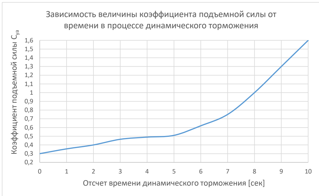
Рисунок 4.7.3 - График задаваемого изменения аэродинамического коэффициента подъемной силы крыла C_{ya} планирующей системы с нагрузкой на крыло 30 \text{ кг/м}^2 и удлинением 3,2 от времени во время динамического торможения
