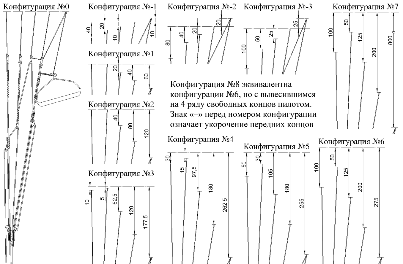
Рисунок 4.3.3 - Смещение свободных концов относительно исходной позиции в зависимости от конфигурации
