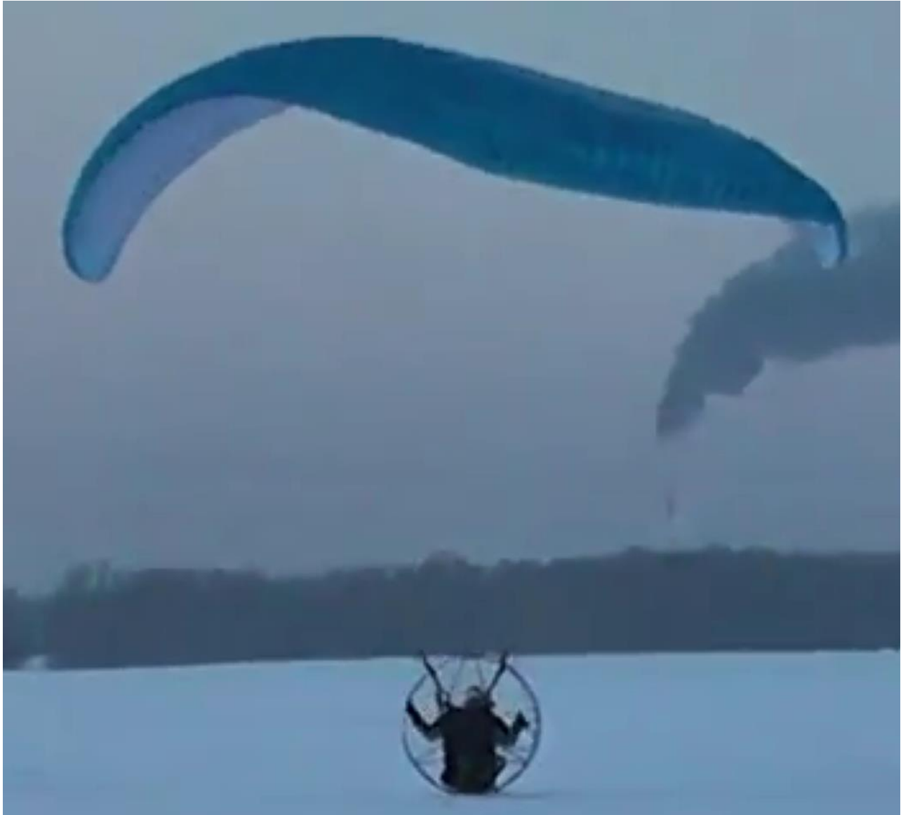
Рисунок Приложение Ж .9ж - Кадр протекания аварийной ситуации. По потере натянутой формы видно, что подвернувшаяся консоль потеряла несущую способность. В подворот уже вовлечен и участок консоли за щелью
