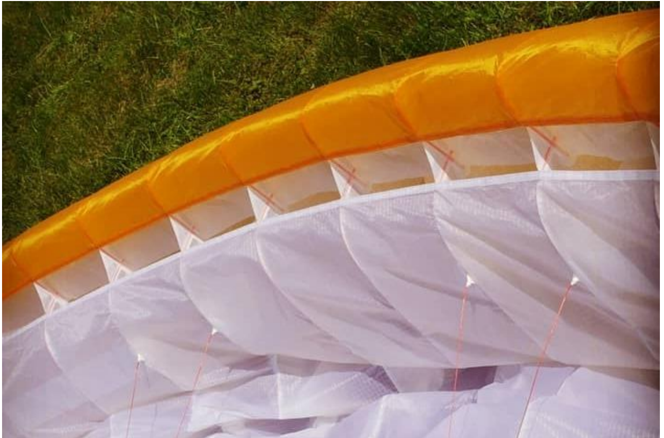
Рисунок Приложение Ж .6 - Горизонтальные клапаны «Smart Nose» на парaparlane Funky компании Davinci gliders
