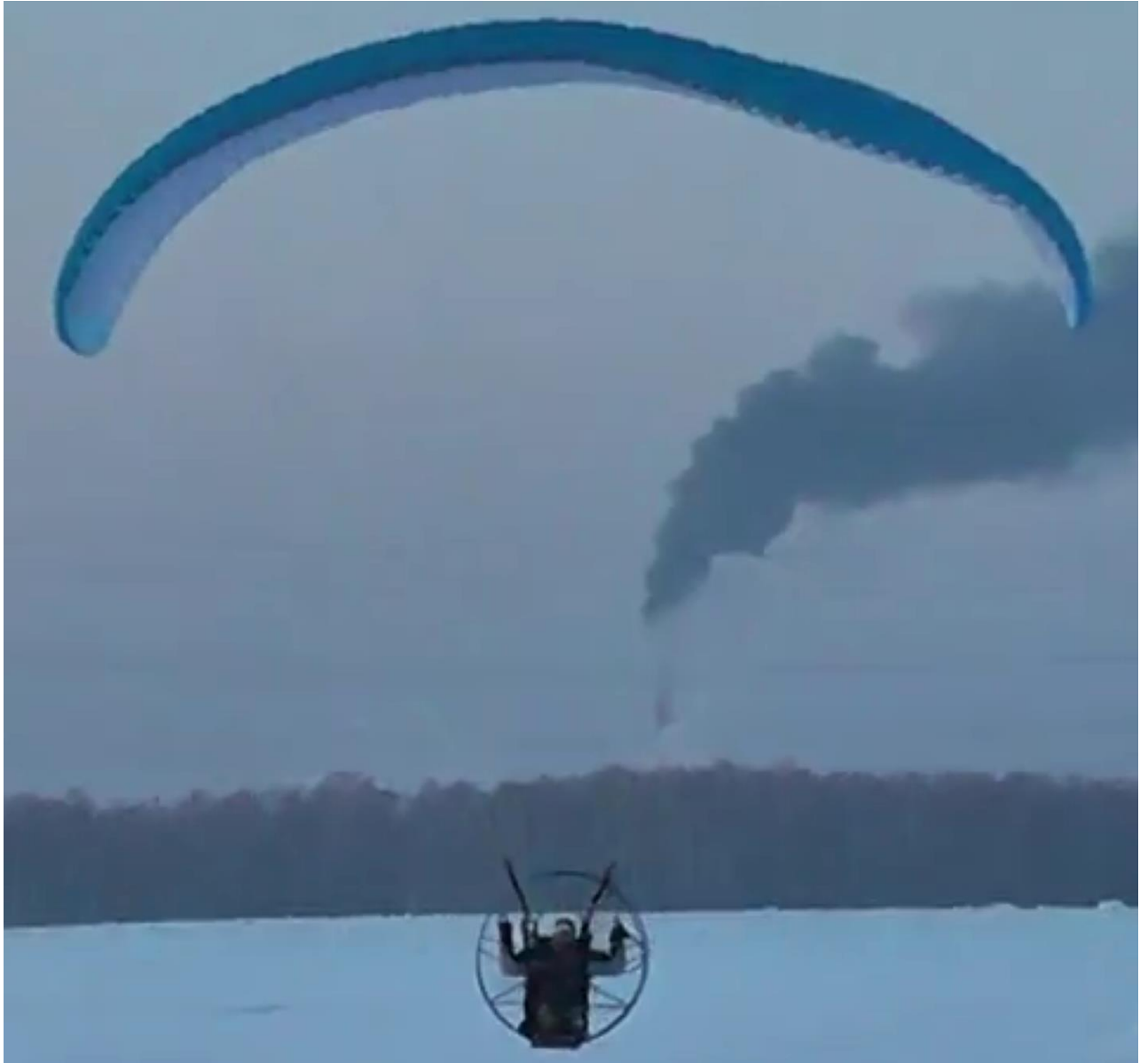
Рисунок Приложение Ж .9г - Кадр протекания аварийной ситуации. Развитие подворота по хорде (однако задняя часть крыла в процесс все еще не вовлечена)
