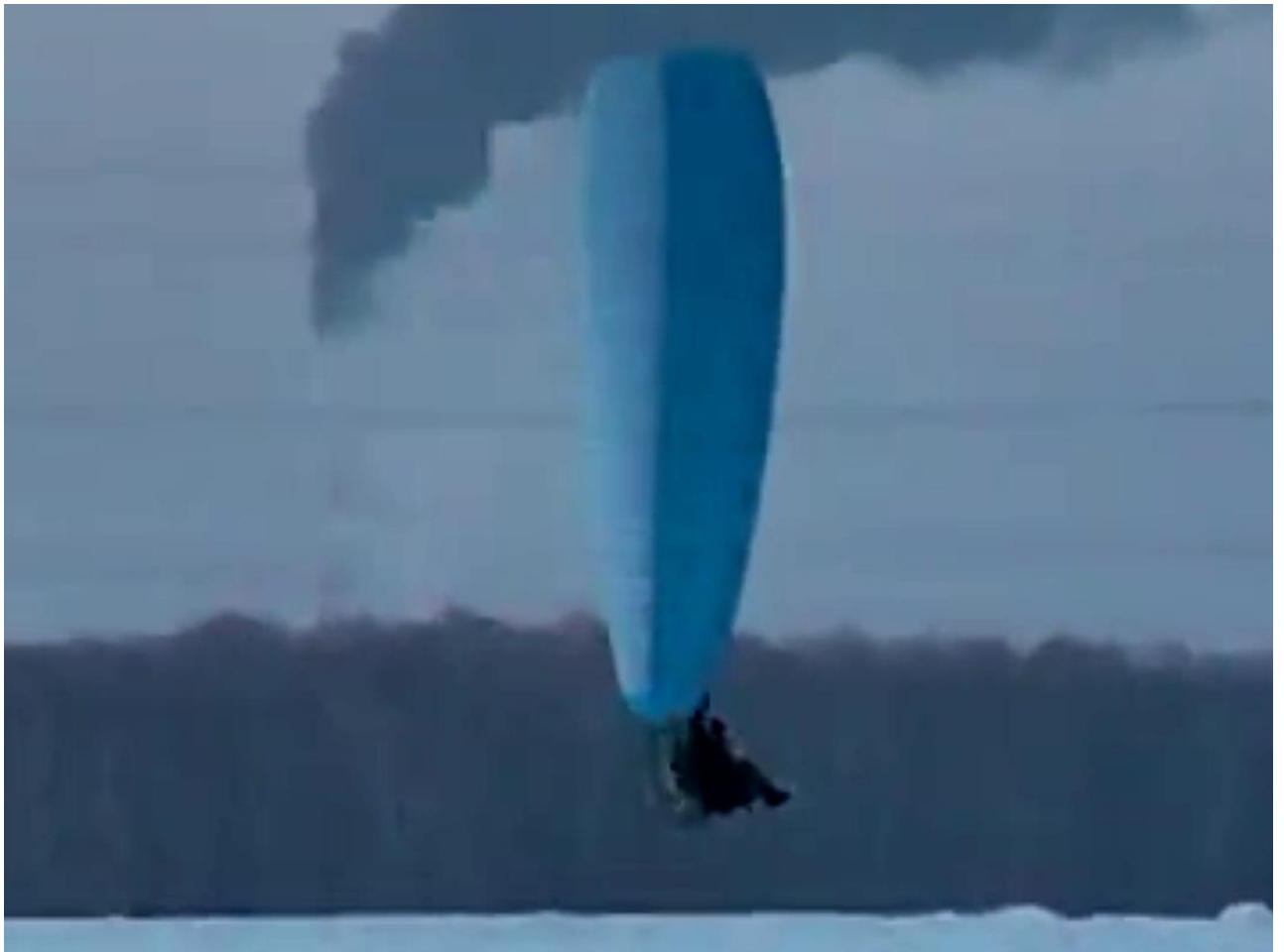
Рисунок Приложение Ж .9а - Параплан Формула-15 на вираже. Видно, что верхняя поверхность крыла выполнена из полотнищ разного цвета. Передняя часть крыла синяя, а участок за щелью – светлый. Щель выполнена на расстоянии 55% от хорды
