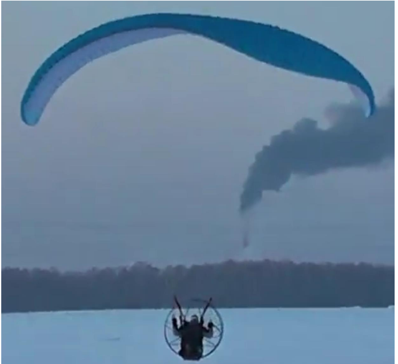
Рисунок Приложение Ж .9д - Кадр протекания аварийной ситуации. Дальнейшее развитие подворота по консоли. Поток пытается окончательно завернуть опустившийся участок крыла, а реактивная тяга от выпускаемого через воздухозаборники воздуха препятствует этому, замедляя процесс
