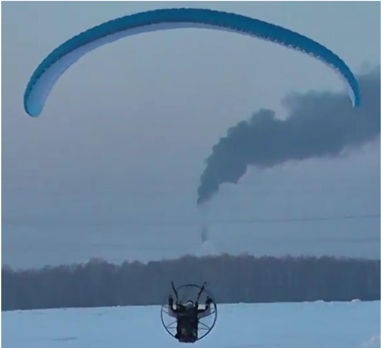
Рисунок Приложение Ж .9в – Кадр протекания аварийной ситуации. Начало подворота левой консоли
