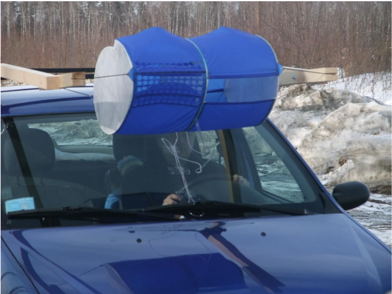
Рисунок 2.10.1 – Продувка секций крыла с клапанами в воздухозаборнике и без них. Все секции клапанов левого сегмента модели носика остаются открытыми вне зависимости от угла атаки
