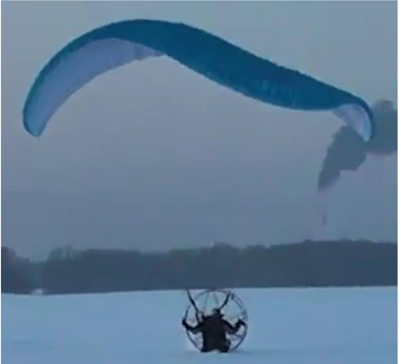
Рисунок Приложение Ж .9.3 - Кадр протекания аварийной ситуации. Деформация консоли начинает возвращаться на передний участок. Видно, что участок за щелью в подвороте уже не участвует, при этом несущая способность консоли еще не восстановлена
