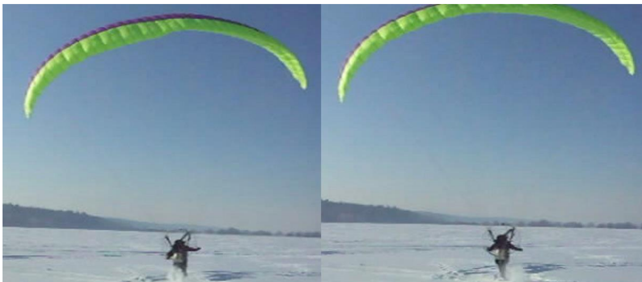
Рисунок 3.7.4 - Вид деформаций крыла на взлетном режиме при работе стропами управления
