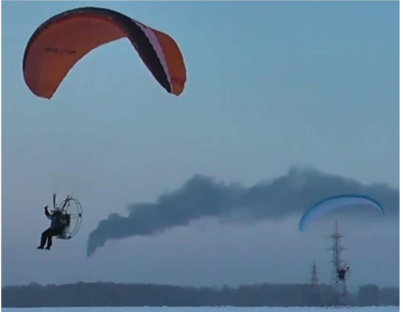
Рисунок Приложение Ж .96 – Момент входа в область, возмущенную пролетевшим впереди крылом
