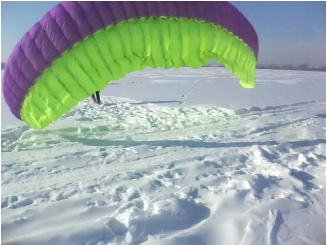
Рисунок 3.7.3 - Формообразование опытного крыла при выводе в полетное положение
