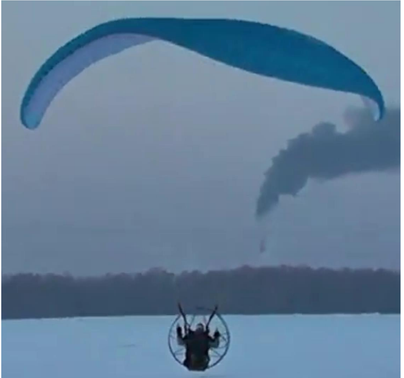
Рисунок Приложение Ж .9е - Кадр протекания аварийной ситуации. Поступающий через нетронутую подворотом консоль воздух продолжает противодействовать подвороту как непосредственно нагнетанием давления, так и истечением через воздухозаборники подвернувшейся части. Начало вовлечения в подворот участка консоли за щелью
