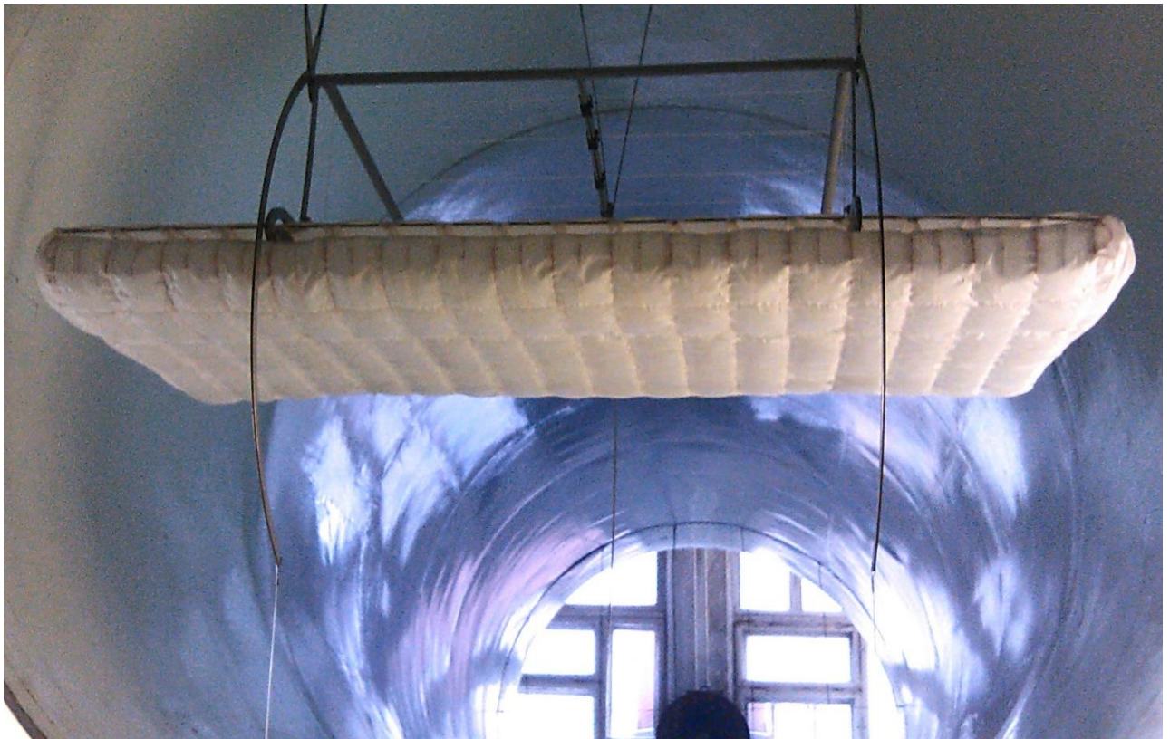
Рисунок 4.5.1 - Форма носика профиля исследуемой модели крыла на нулевых и отрицательных углах атаки. Заметно подмятие передней кромки и выпячивание воздухозаборника, приводящие к сохранению устойчивой формы крыла. Использование данного эффекта на малых углах атаки может повысить безопасность мягких крыльев
