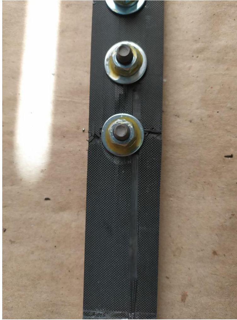
Рисунок 5.17 – Разрушение образца композитного соединения при статических испытаниях
