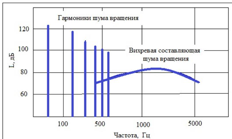
Рис. 2 Типичный спектр шума воздушного винта
