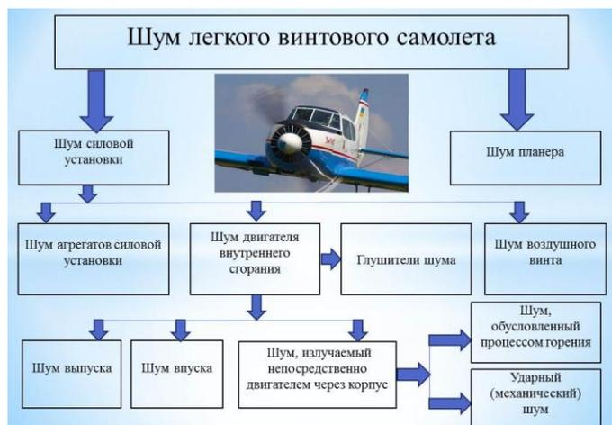
Рисунок 1 - Структурная схема составляющих шума легкого винтового самолета
