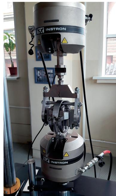
Рис. 4. Изготовленный демонстратор демпфера на испытательной машине
