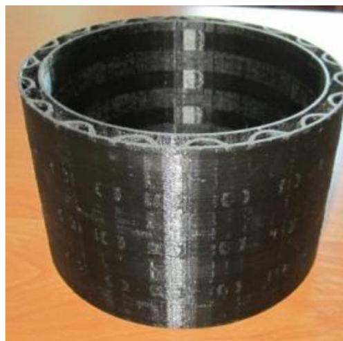
Рис. 6. Демонстрационный образец цилиндрической оболочки.
